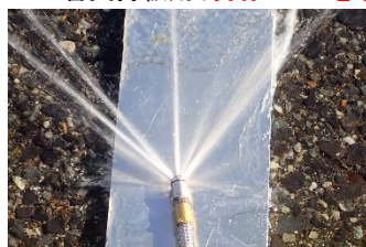
第3～6管支持板用(噴射ノズルを改良)
