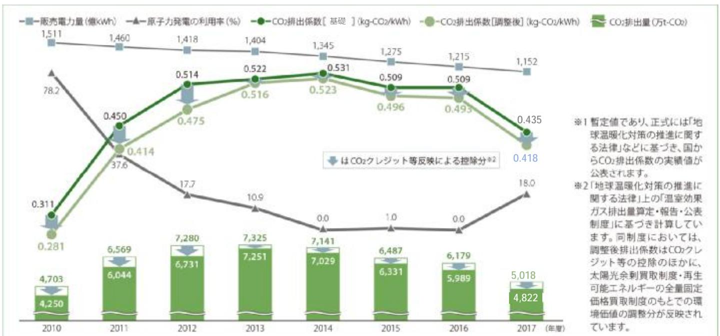
2017年度のCO<sub>2</sub>排出係数は、0.418kg-CO<sub>2</sub>/kWh<sup>※1</sup>（調整後）となり、前年度と比較して大幅に改善しました。その主な要因としては、当社の低炭素化に向けた取組みとして、原子力や水力、姫路第二発電所の高効率天然ガス発電設備の利用率が増加したことが挙げられます。
