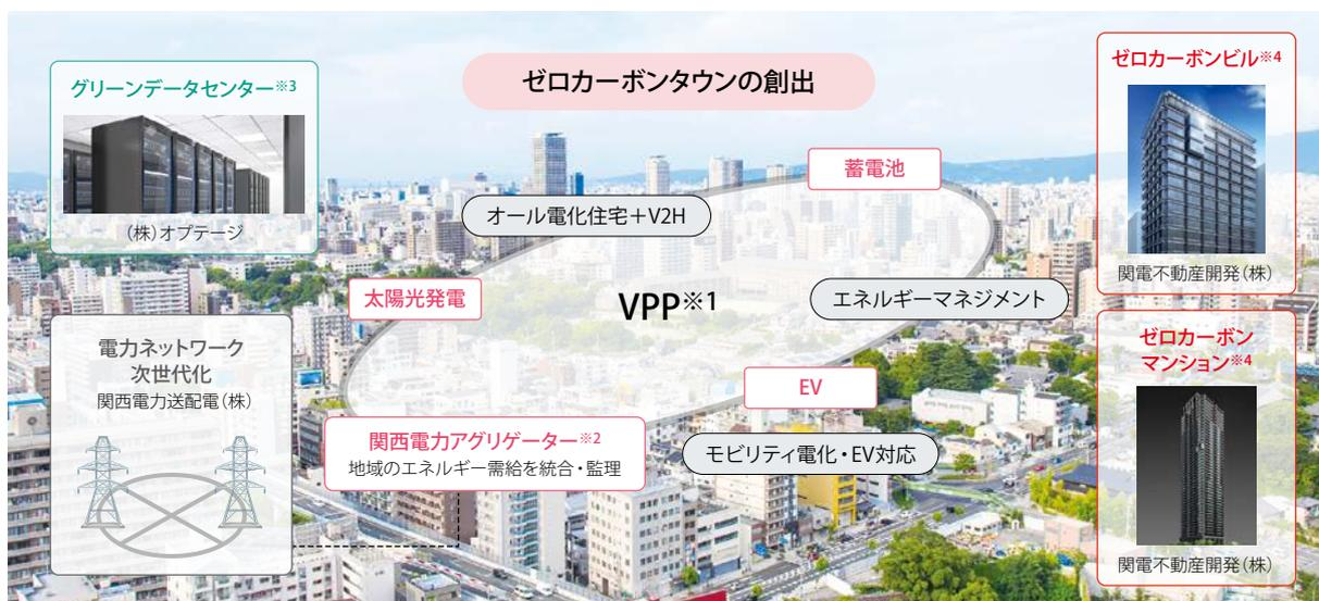
※1 VPP: バーチャルパワープラントの略。分散型エネルギーを統合制御し、電力需給バランス調整に活用することであたかも一つの発電所のように機能させる仕組み
