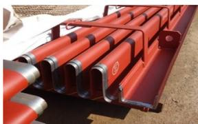
設備改善の一例(御坊発電所3号機)。耐熱性の高い「金属製」の伸縮継手に交換
