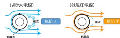
●低風圧アルミ電線の原理
