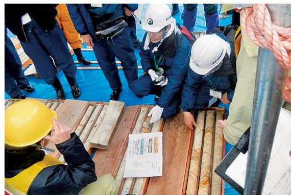
敷地内で実施したボーリング試料の確認
