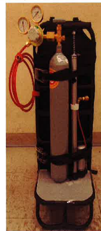
窒素ポンプ、エアーコンプレッサー 運搬用背負子(搭載状況)
