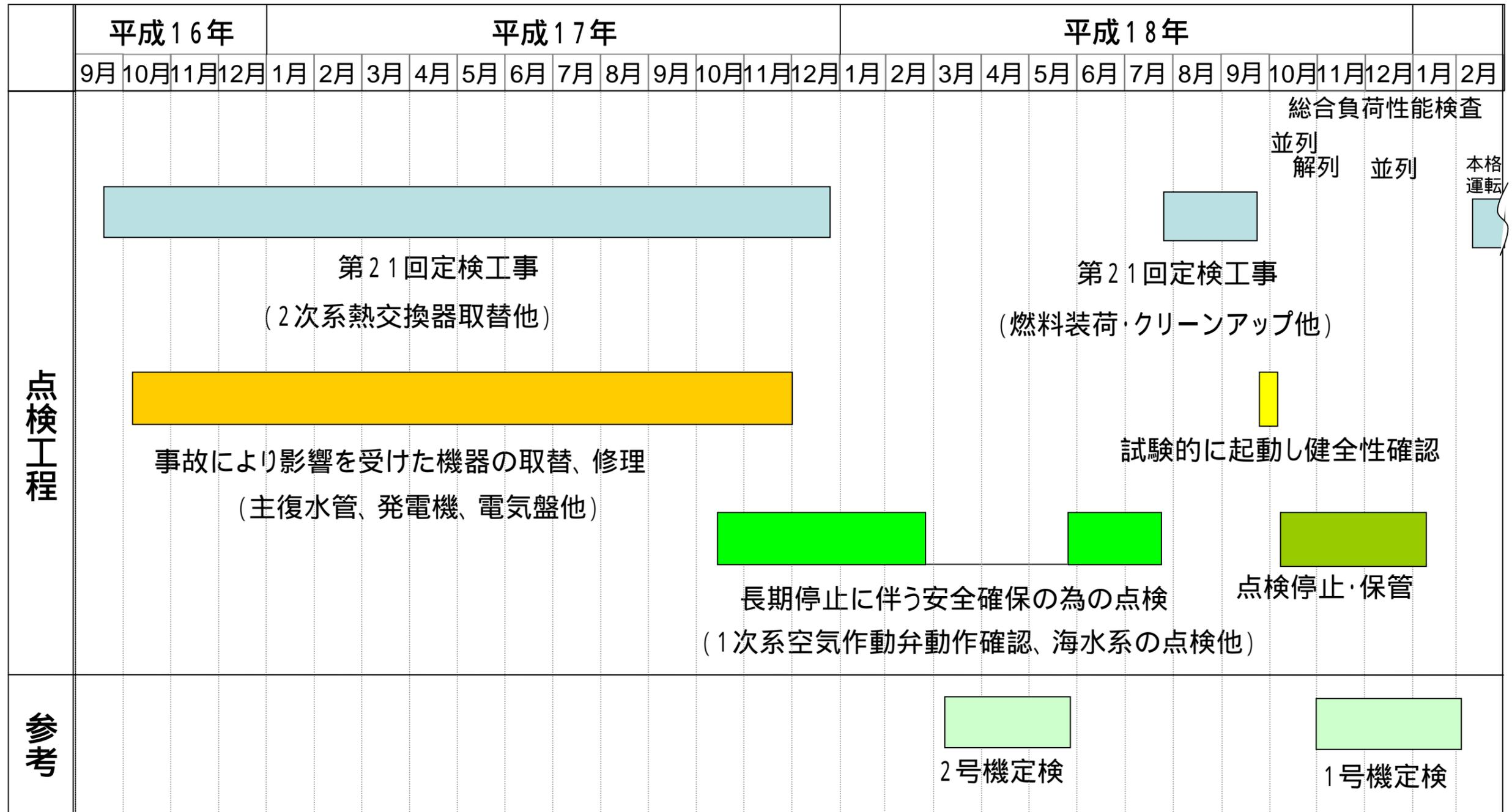
通常の定期検査工事に加え、事故や長期停止による影響も考慮し、発電所全体を点検、清掃。その上で試験的に起動して機器の健全性を確認し、更に停止してプラント全体の点検を実施。
