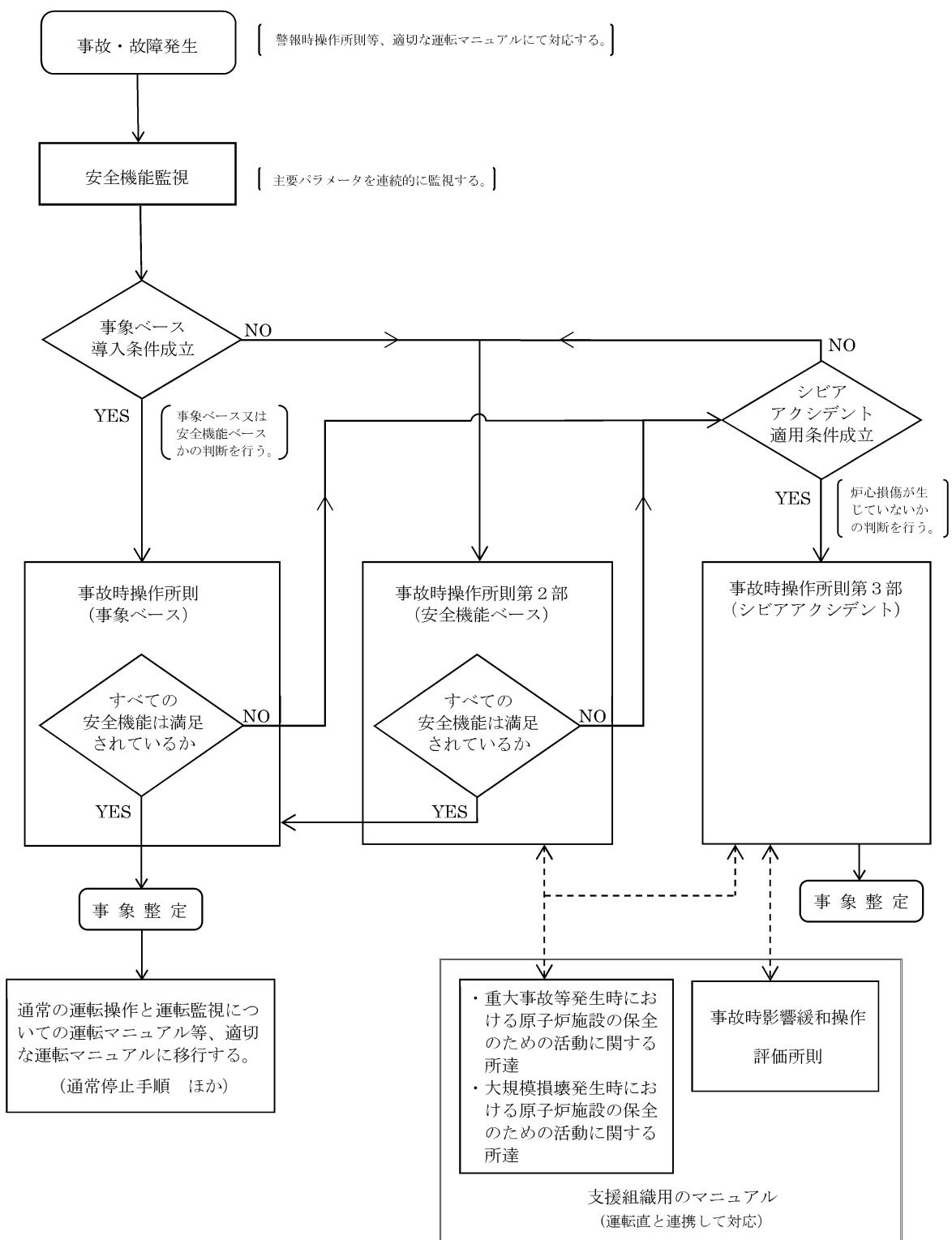
第 2.2.1.2.6 図 事故・故障時の運転マニュアルの使用フロー
