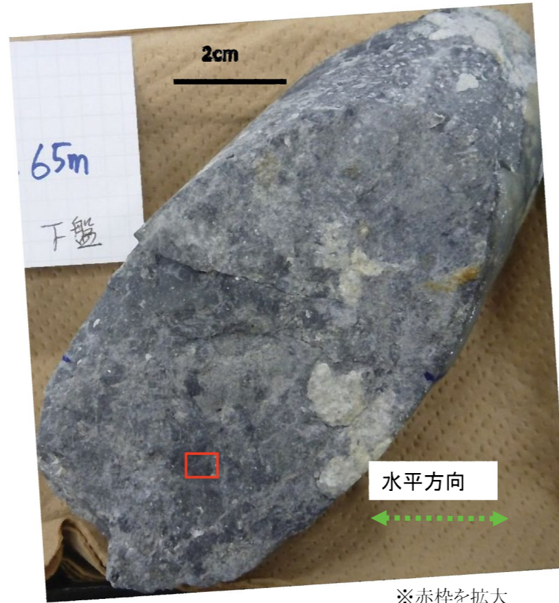
H25-5 51.55-51.65mの断層面(下盤上面)
