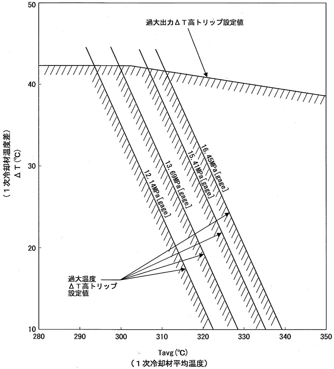
(1次冷却材の温度・圧力および1次冷却材温度変化率)
