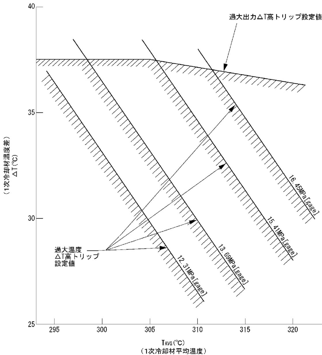
図 35-2 過大温度 $\Delta T$ 高および過大出力 $\Delta T$ 高トリップ設定値制限図
