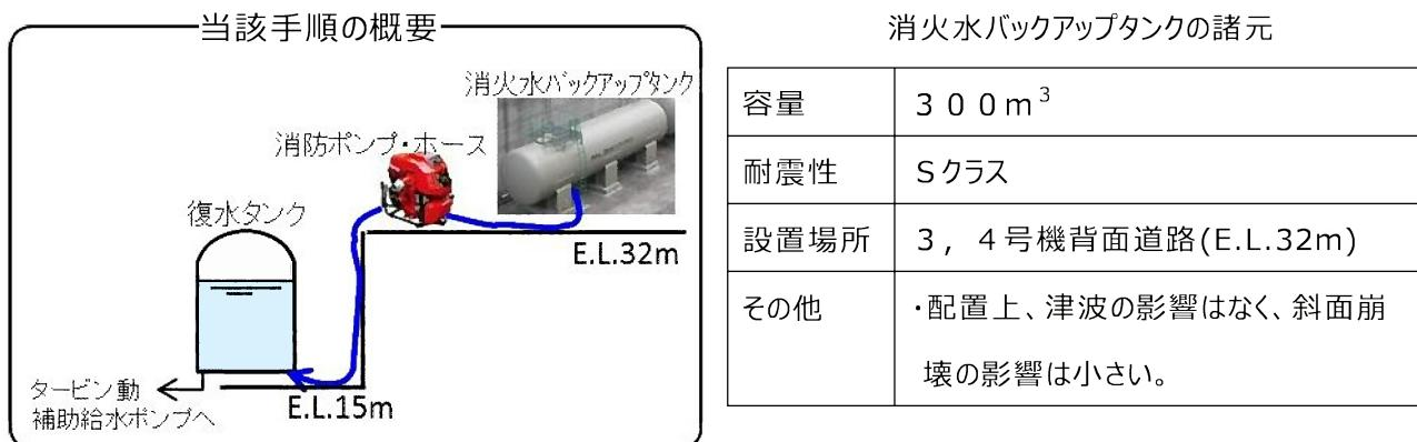
第 3.1.4.5.3 図 消火水バックアップタンクによる復水タンク補給の概要
