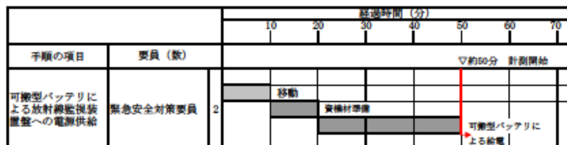
第 1.15.7 図 可搬型バッテリーによる放射線監視装置盤への電源供給 タイムチャート
