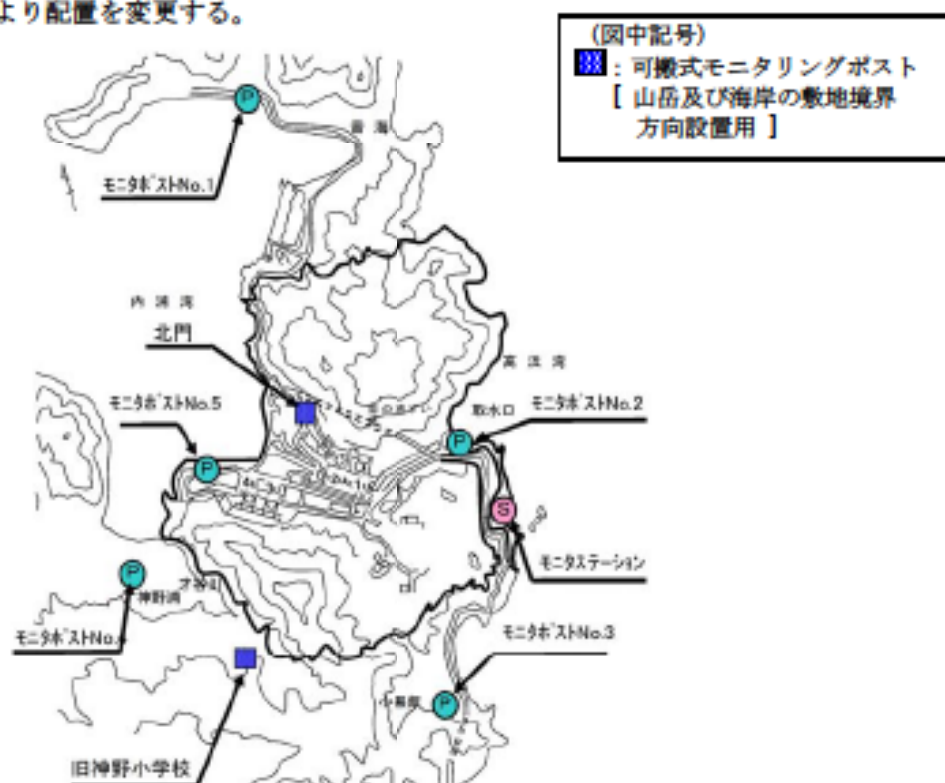
第 1.17.4 図 可搬式モニタリングポスト配置位置 (発電所山岳及び海岸方向への設置)
