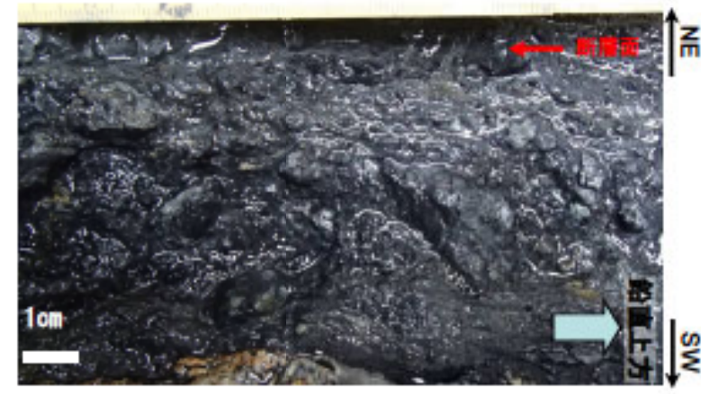
写真 k 左横ずれ南上がりセンスを示す変形指標
