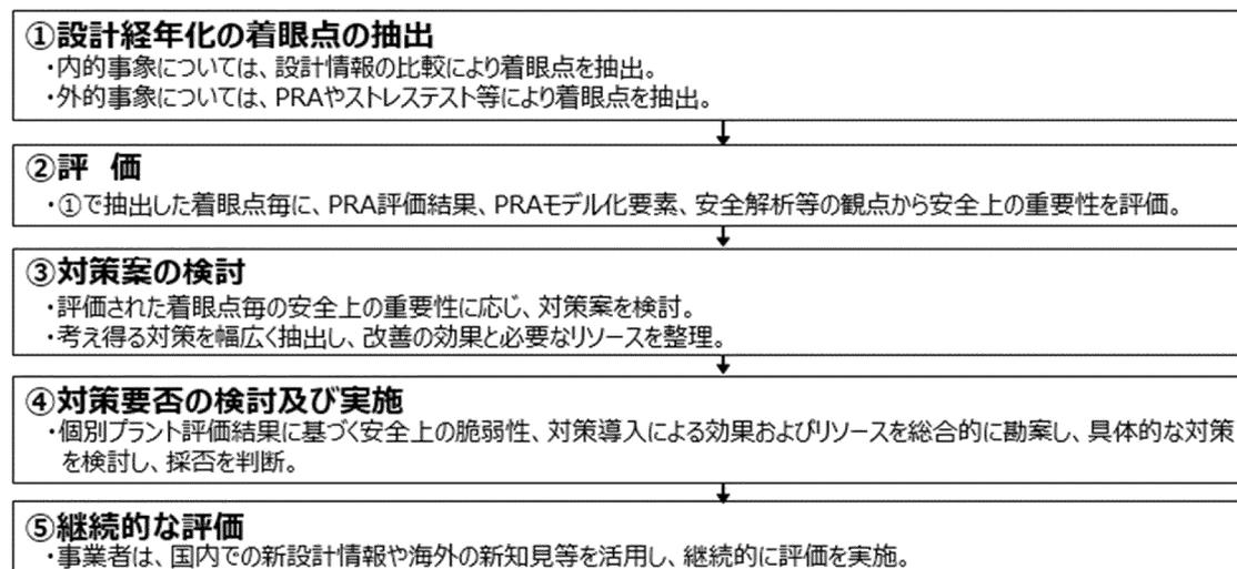
第 2.4.3 図 設計の経年化評価ガイドラインの評価フロー概要
