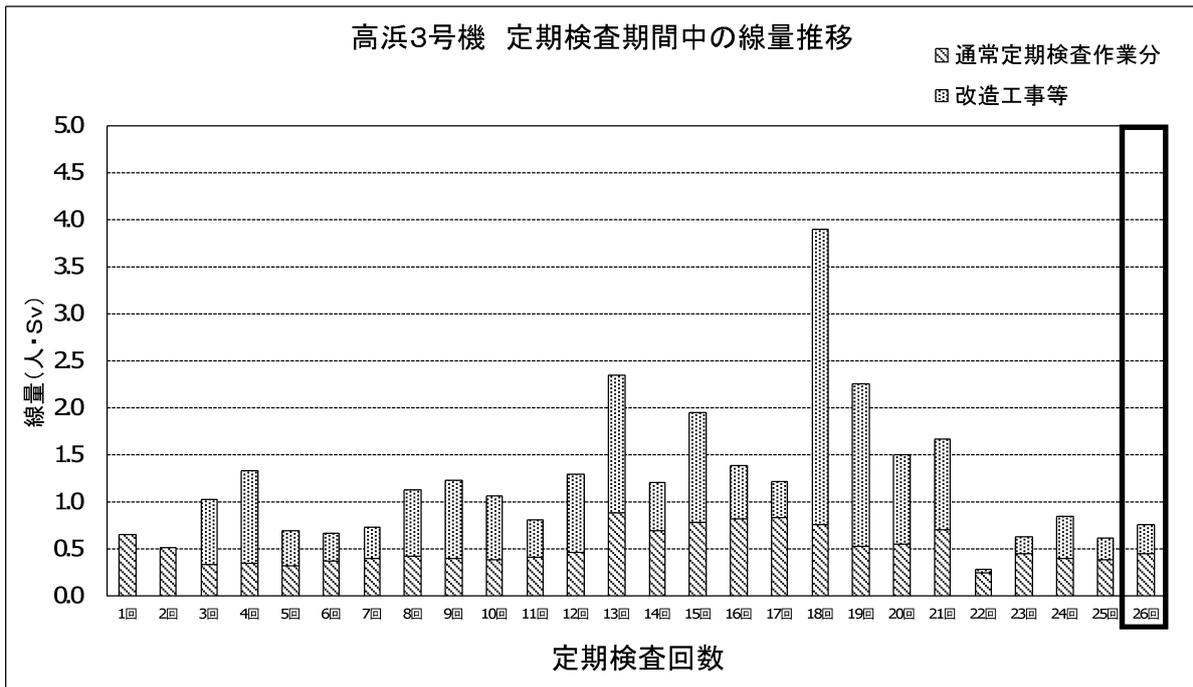
第 2.2.1.5.1 図 定期検査期間中の線量の推移（高浜発電所 3 号機）
