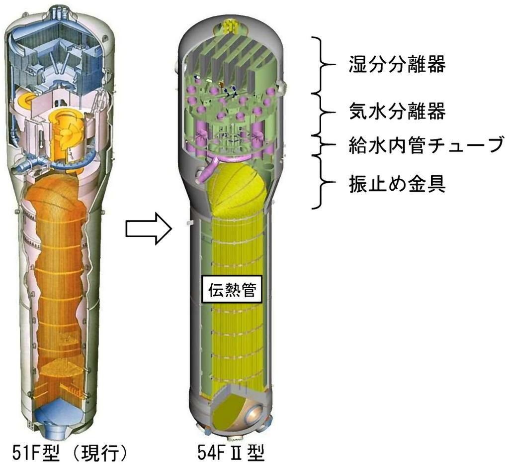
第 2.4.1 図 蒸気発生器取替のイメージ
