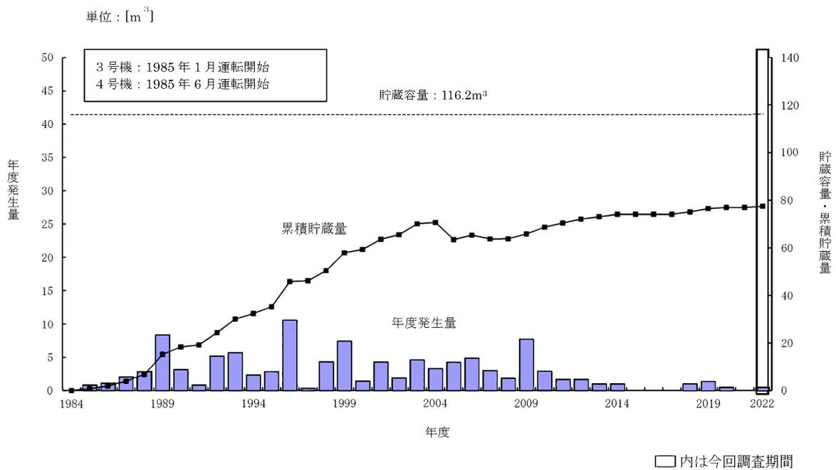
第 2.2.1.6.6 図 脱塩塔使用済樹脂の発生量、貯蔵量の推移
