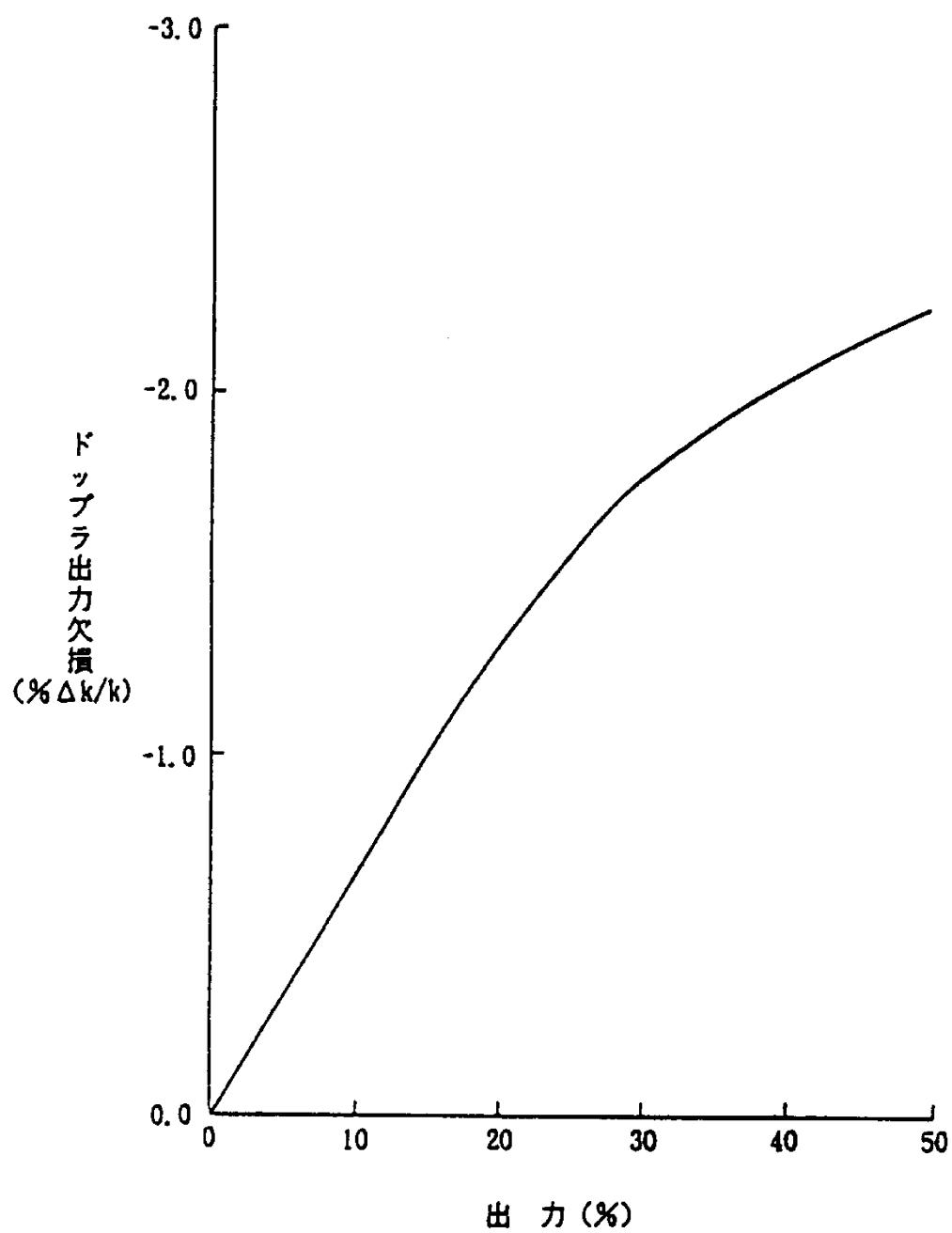
第 1.5.3.1 図 解析に使用したドップラ出力欠損
