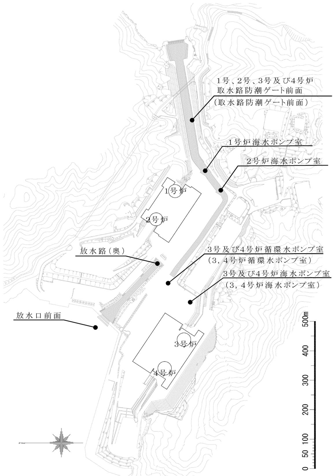
第 1.2.7.2.4 図 津波水位評価点位置図
