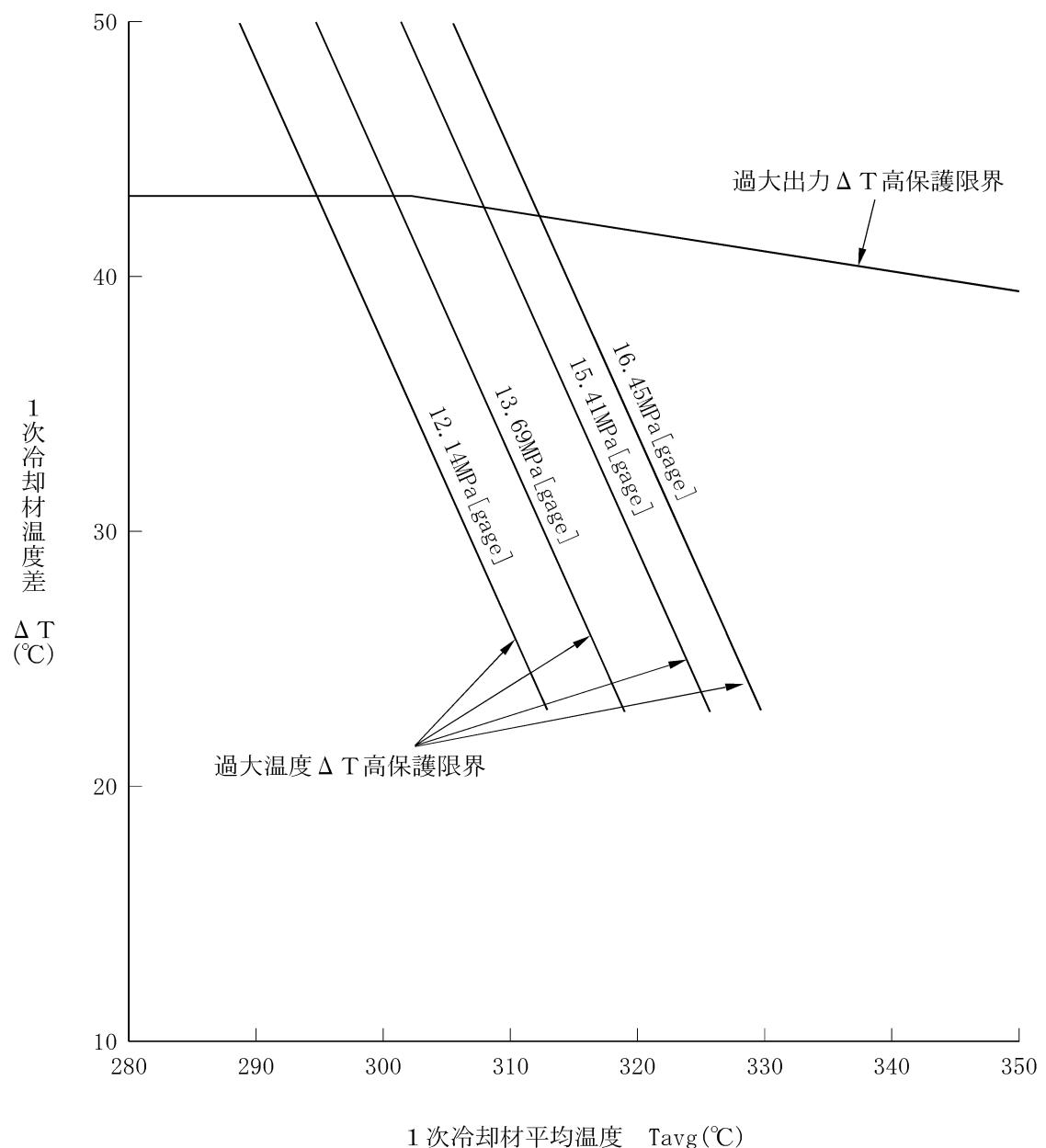
第 1.5.2.1 図 過大出力  $\Delta T$  高及び過大温度  $\Delta T$  高による保護限界図
