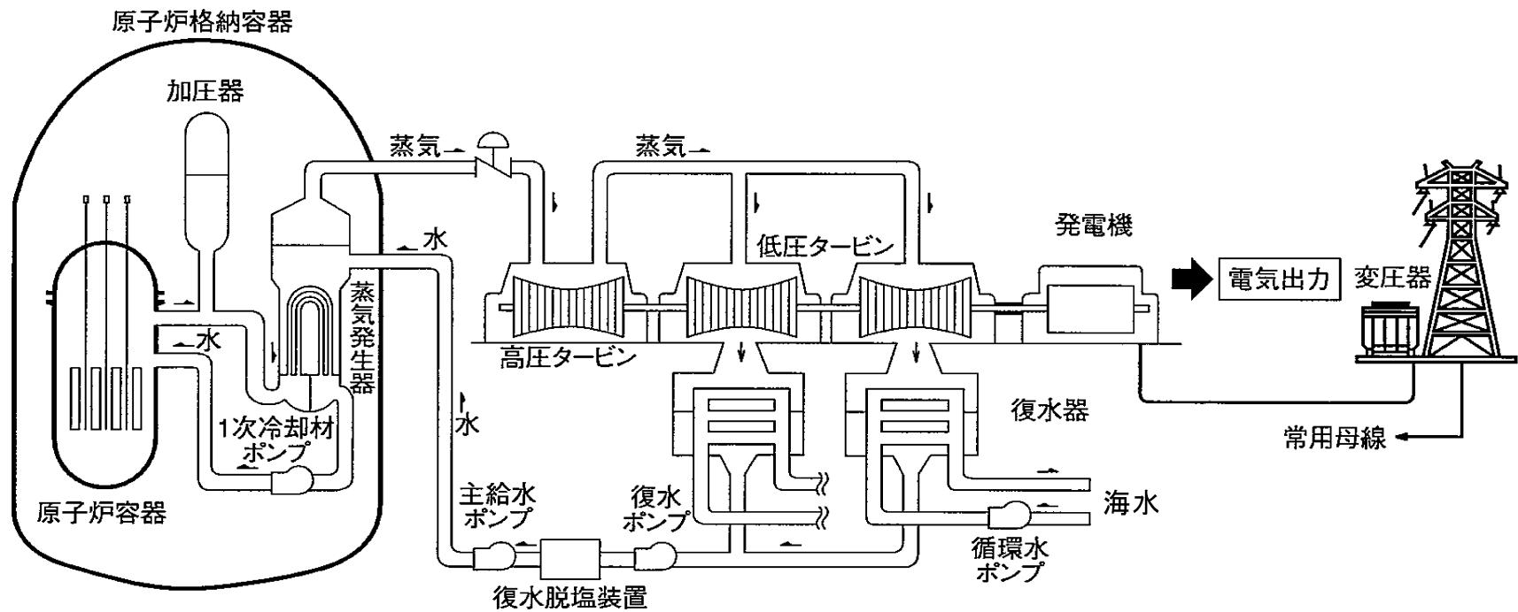
第 1.1.2.1 図 高浜発電所 3, 4 号機系統概要図
