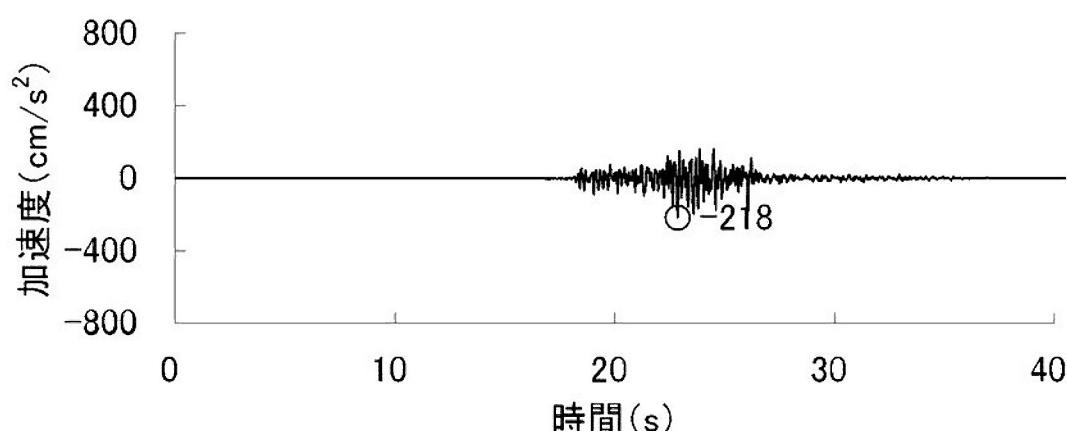
加速度 (鉛直方向 : Ss-4<sub>V</sub>)
