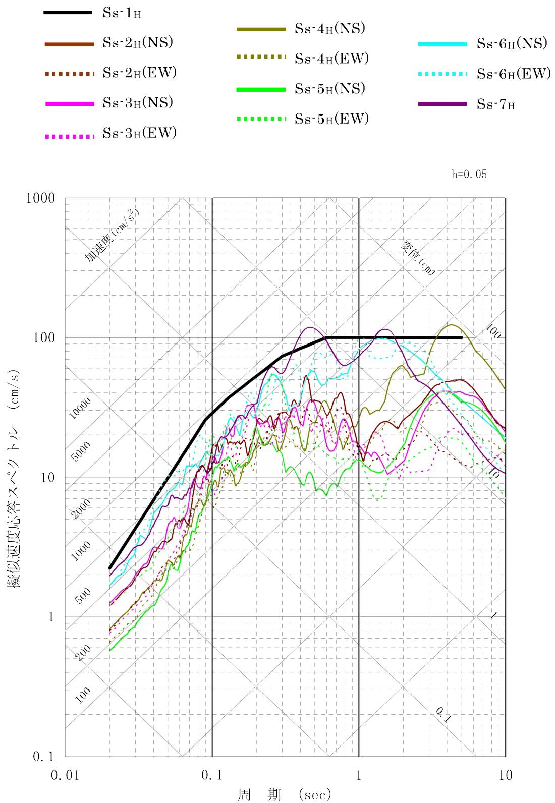
第 1.3.2.1 図 基準地震動 Ss の応答スペクトル (水平方向)
