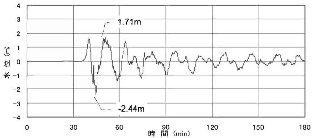
基準津波 1 若狭海丘列付近断層と隱岐トラフ海底地すべりを波源とする時刻歴波形
