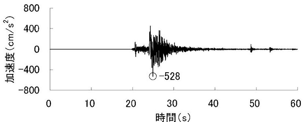
加速度 (水平方向 : Ss-6<sub>H</sub>(NS))
