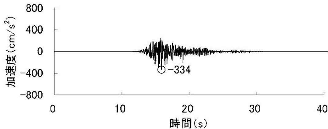
加速度 (鉛直方向 : Ss-2<sub>V</sub>)
