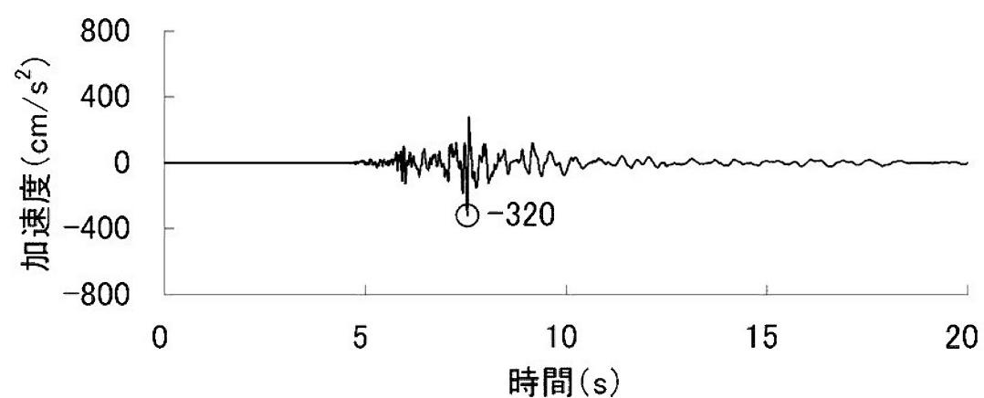
加速度（鉛直方向 : Ss-7<sub>V</sub>）
