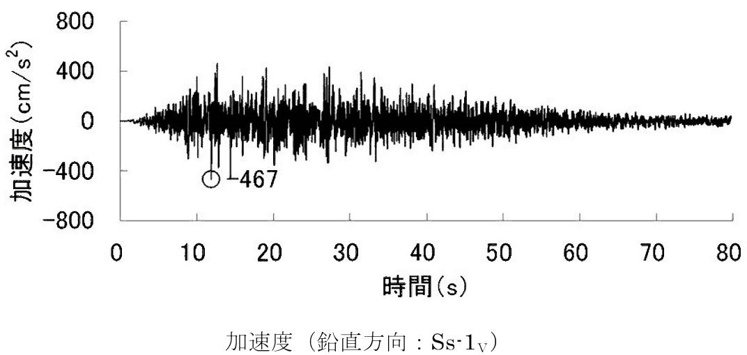
第 1.3.2.3 図 基準地震動  $\text{Ss}\cdot\mathbf{1}$  の設計用模擬地震波の時刻歴波形
