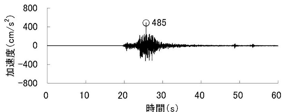
加速度 (鉛直方向 : Ss-6<sub>V</sub>)
