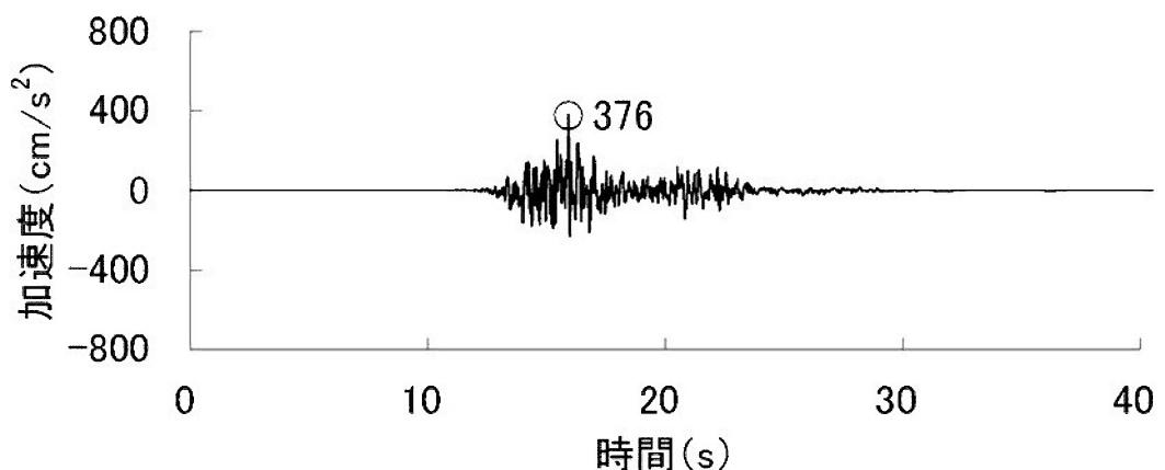
加速度 (水平方向 : Ss-2<sub>H</sub>(NS))
