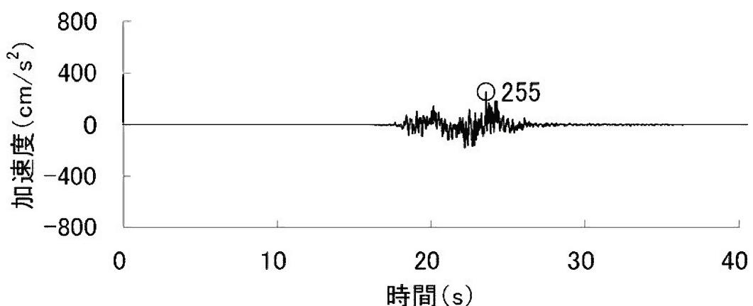
加速度 (水平方向 : Ss-4<sub>H</sub>(NS))
