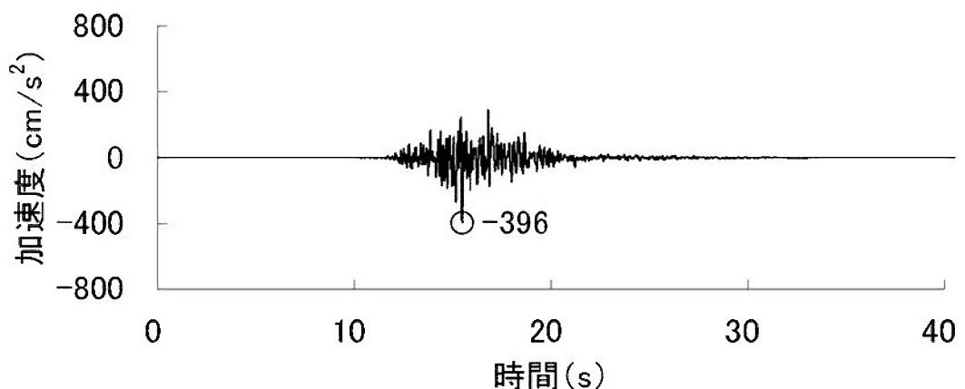
加速度 (水平方向 : Ss-3<sub>H</sub>(NS))
