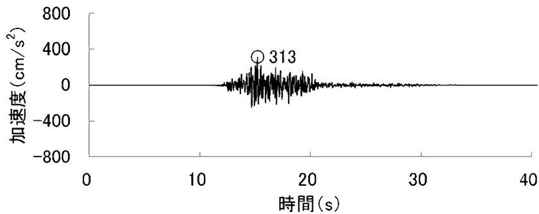
加速度 (鉛直方向 : Ss-3<sub>V</sub>)
