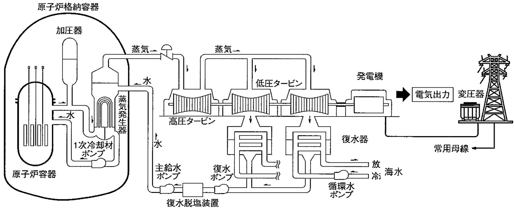
第 1.1.2.1 図 高浜原子力発電所系統概要図
