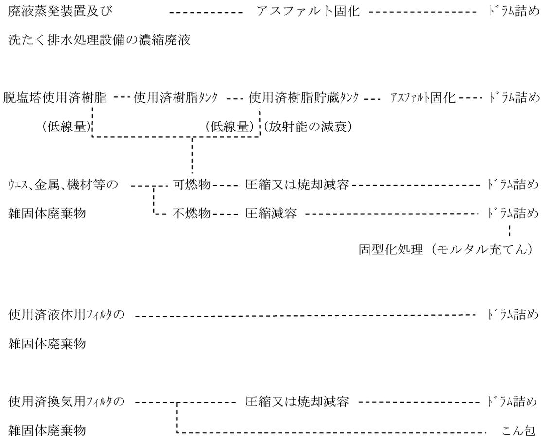
固体廃棄物処理設備は、廃棄物の圧縮、焼却、固化等の処理を行う過程において放射性物質が飛散しないような措置を講じている。
