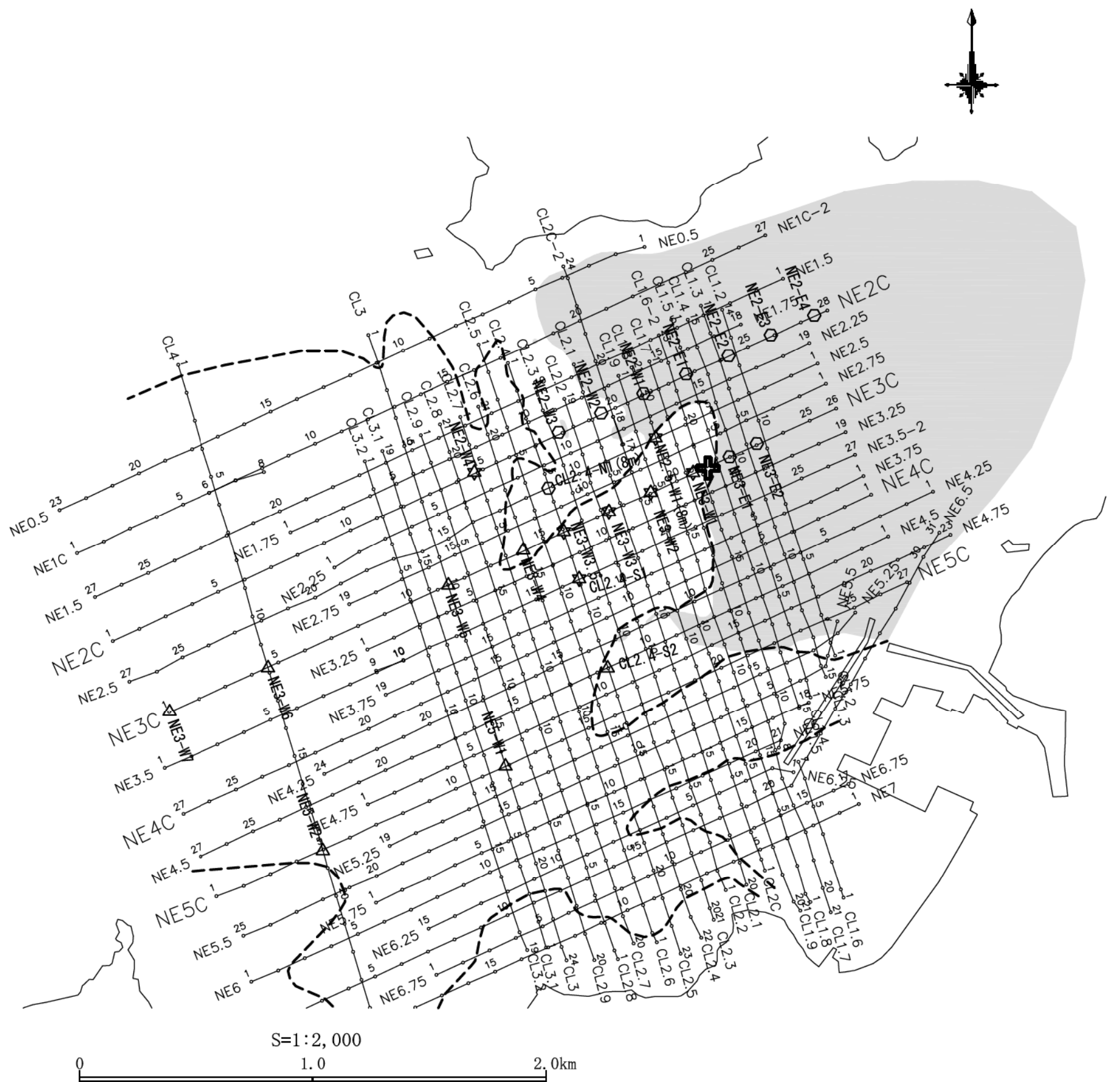
第1.3.150図 保安院調査による変形構造確認箇所付近における柱状採泥結果
