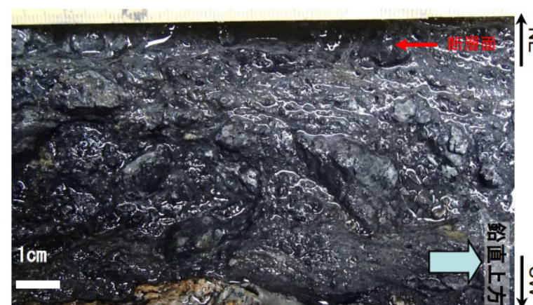
写真 k 左横ずれ南上がりセンスを示す変形指標
