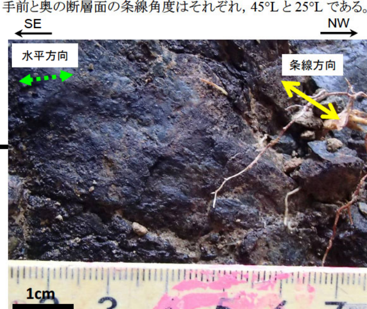
写真 e 断層面の上盤下面
