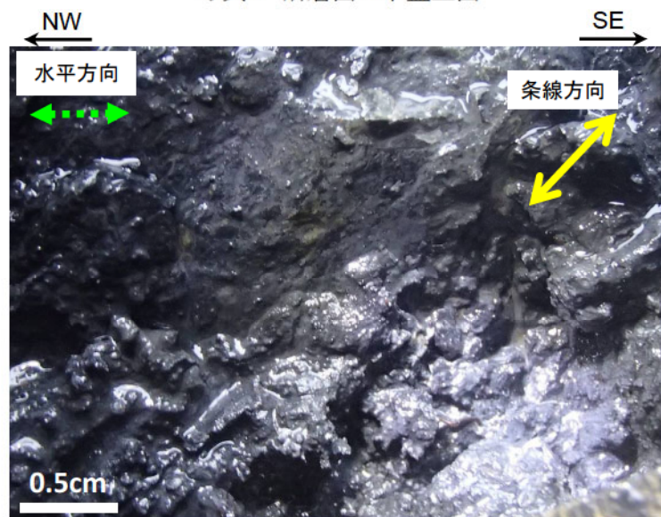
写真 d 断層面の下盤上面 条線はやや不明瞭
