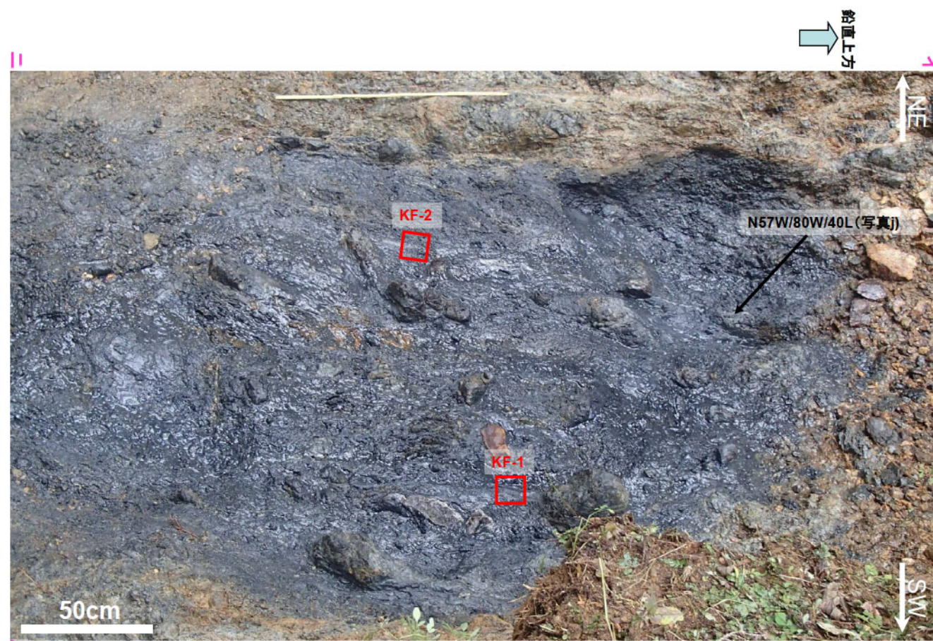
写真 A 左横ずれ逆断層 (南上がり)センスを示す変形指標が発達(P フォリエーションなど)
