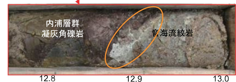
第 1.2.3.3.30 図(1) 音海流紋岩と内浦層群の境界部のボーリング調査結果（T1-16 孔、T1-16' 孔）
