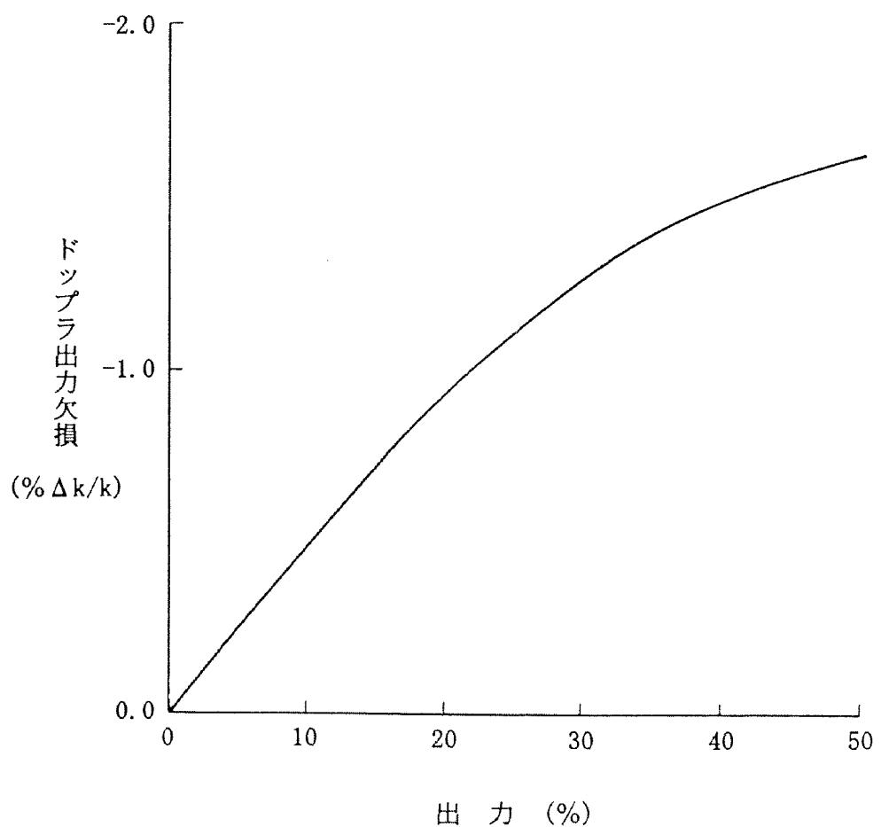
第 1.5.2.5 図 解析に使用したドップラ出力欠損
