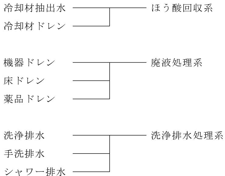
液体廃棄物処理設備により処理した後の処理水は、試料採取、分析（放射性物質濃度、化学分析）を行い、再使用するか又は放射性物質濃度が十分に低いことを確認したうえで、モニタによって監視しながら復水器冷却水と混合、希釈して放出する。
