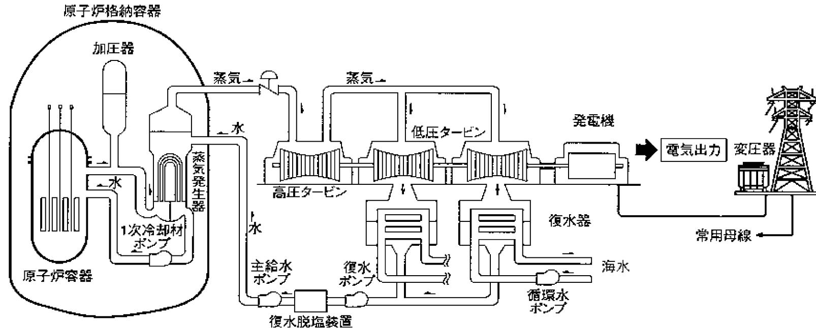
第 1.1.2.1 図 大飯原子力発電所系統概要図
