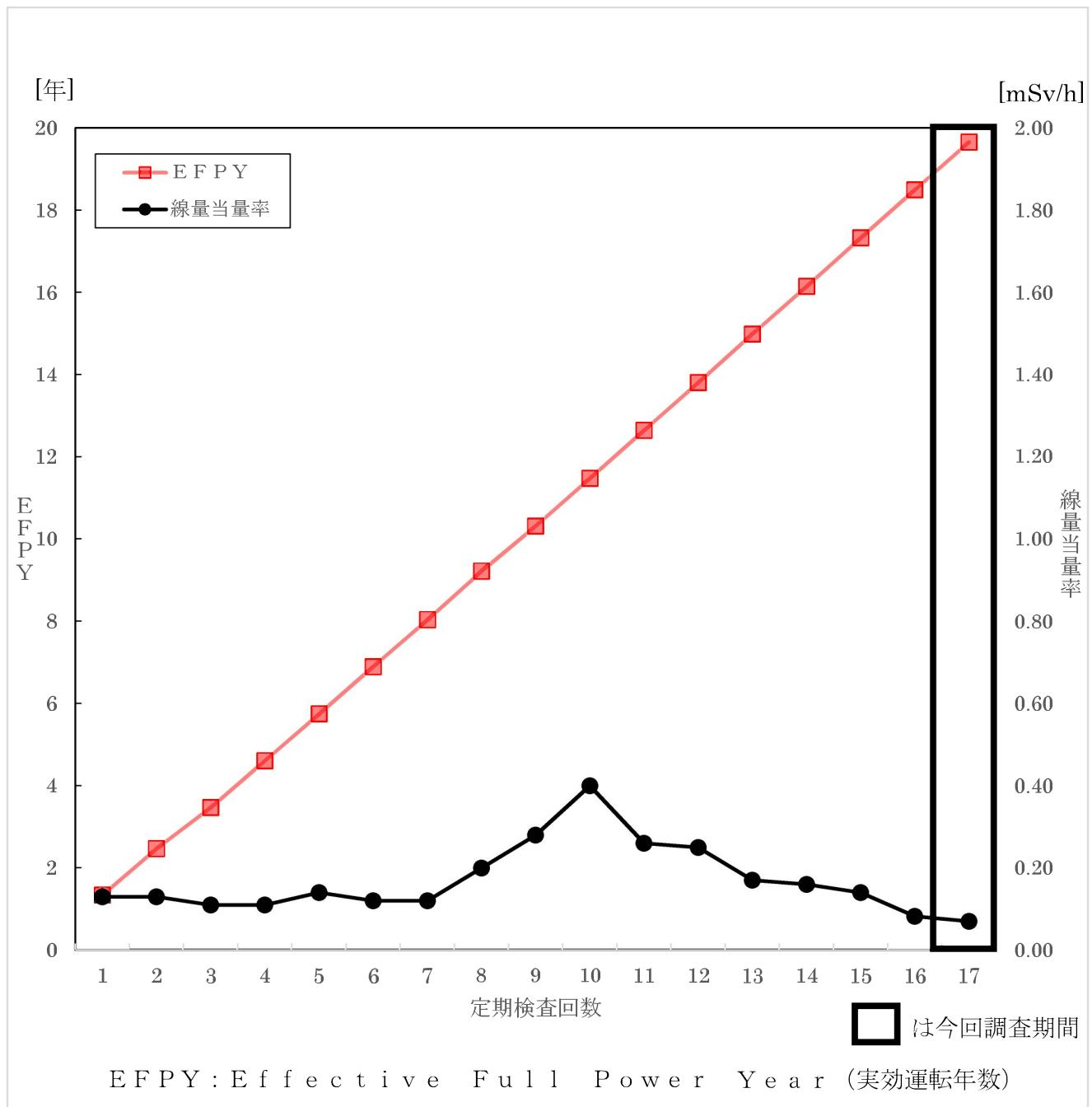
第 2.2.1.5.3 図 1 次冷却材配管表面線量当量率の経年変化
