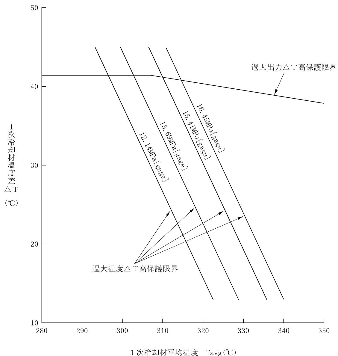
第 1.5.2.1 図 過大出力  $\Delta T$  高及び過大温度  $\Delta T$  高による保護限界図
