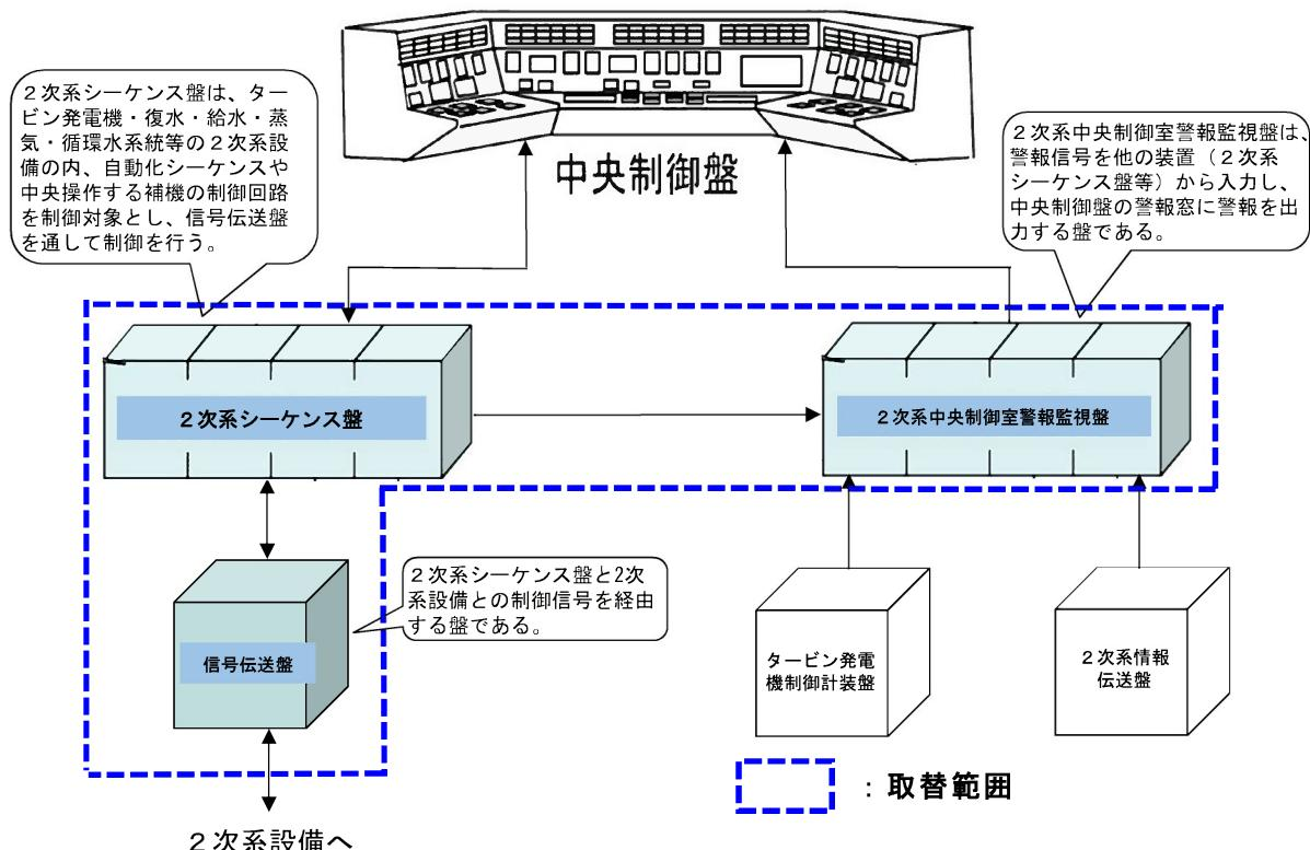
第 2.4.1 図 2次系シーケンス盤他取替工事の概要
