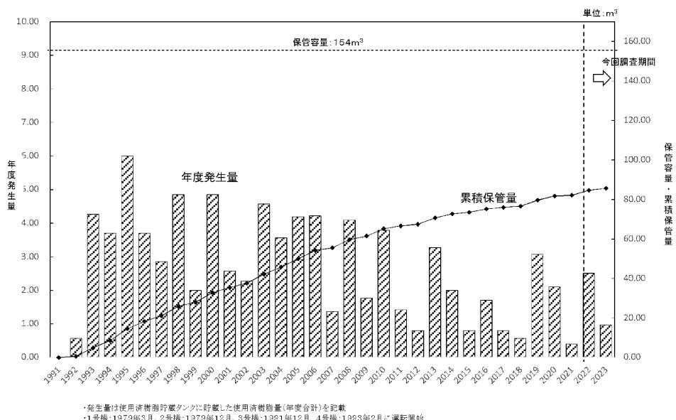
第 2.2.1.6.6 図 脱塩塔使用済樹脂の発生量、保管量の推移
