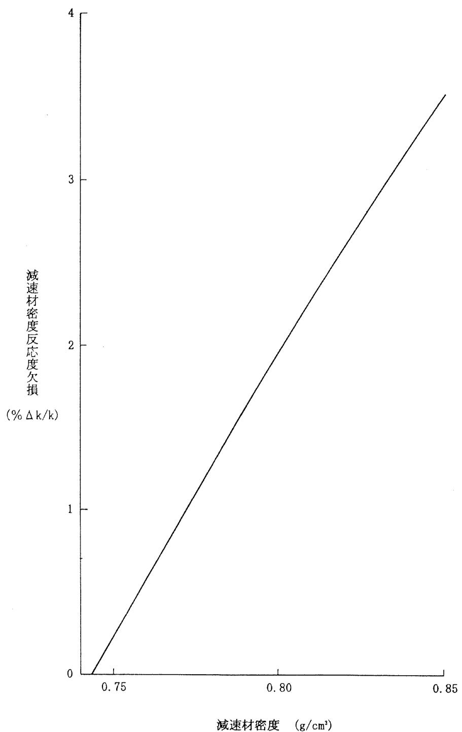
第 1.5.3.2 図 解析に使用した減速材密度反応度欠損
