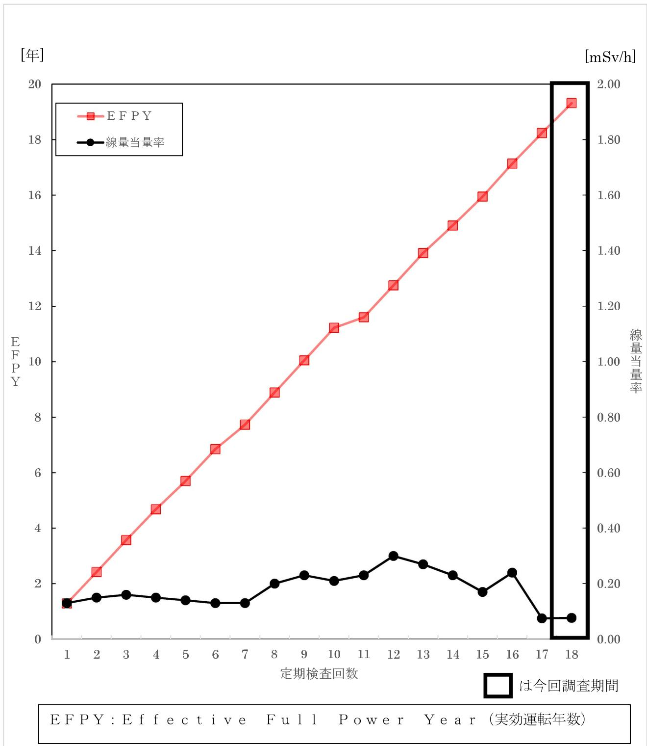
第 2.2.1.5.3 図 1 次冷却材配管表面線量当量率の経年変化
