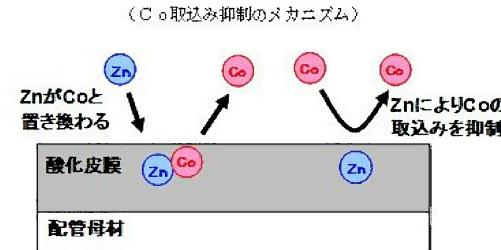
(Co取り込み抑制のメカニズム)
