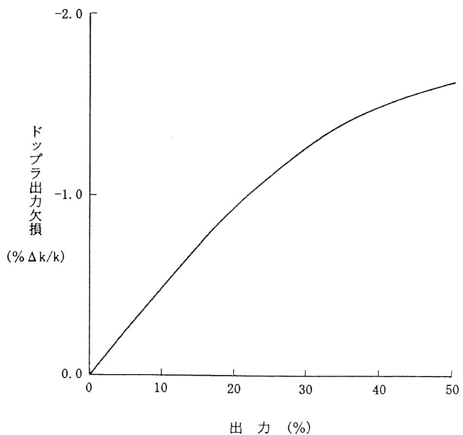
第 1.5.3.3 図 解析に使用したドップラ出力欠損
