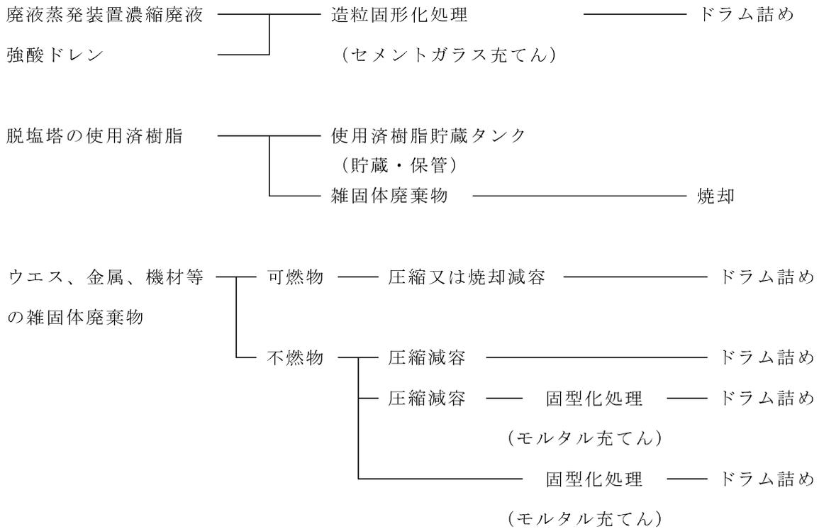
固体廃棄物処理設備は、廃棄物の圧縮、焼却、固化等の処理を行う過程において放射性物質が飛散しないような措置を講じている。また、この設備からの排ガスはフィルタを通して、モニタによって監視しながら排気筒より放出する。
