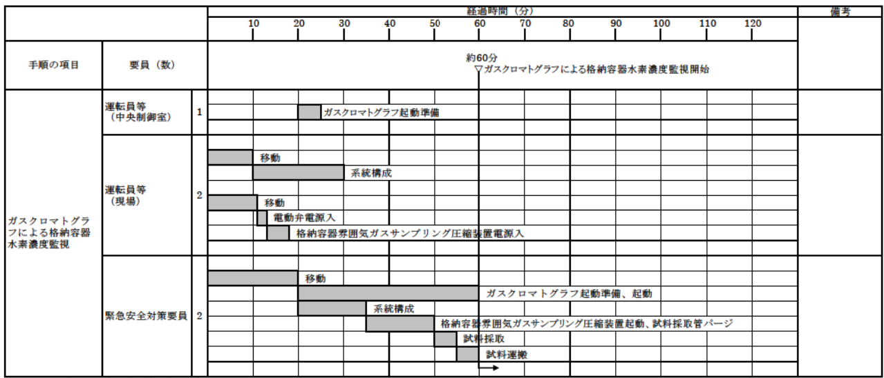
第1.9.9図 ガスクロマトグラフによる格納容器水素濃度監視 タイムチャート
