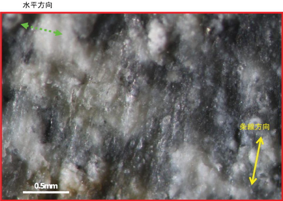
断層面の状況
