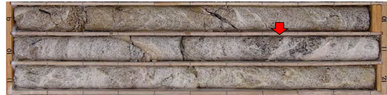
M1-14孔 10.75m付近 粘土状破碎部(N19E/75W)
