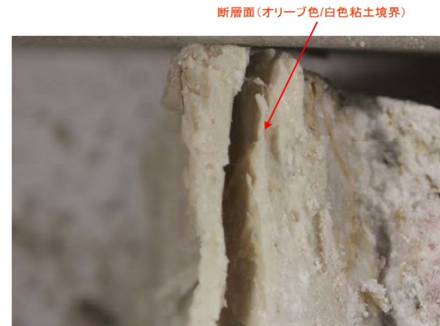
断層面の断面写真
