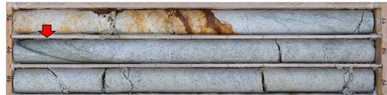
M1-13孔 77.1m付近 粘土状破碎部(N22E/68W)
