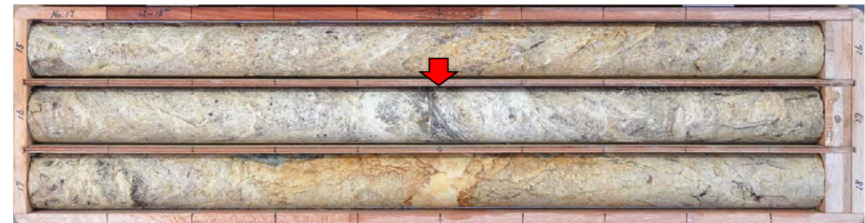
No.17孔 16.5m付近 粘土状破碎部(N14W/60W)
