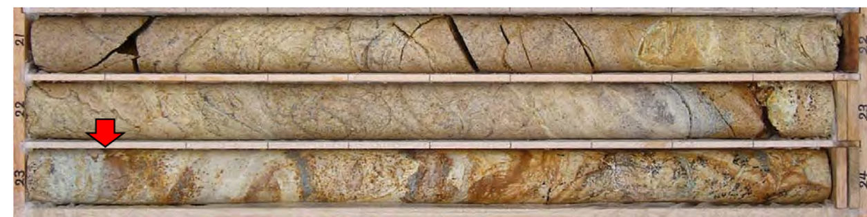
M1-13孔 23.1m付近 粘土混じり角礫状破碎部 (N23E/63E)
