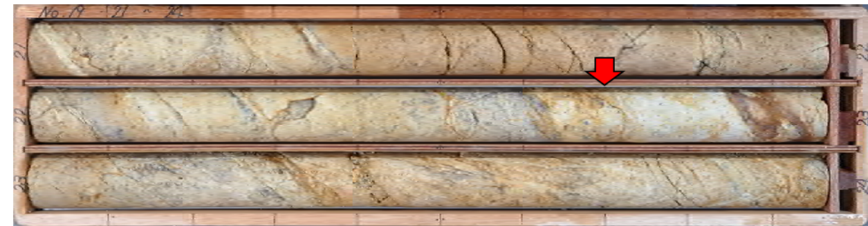
No.19孔 22.7m付近 礫混じり粘土状破碎部 (N32E/82SE)
