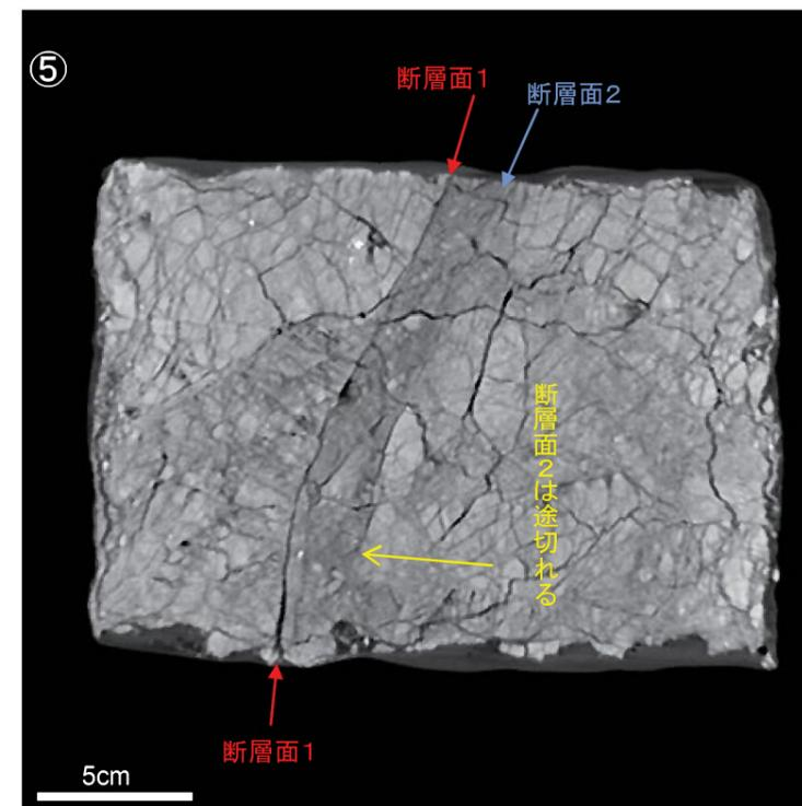
CT画像による試料内部の連続観察から、断層面1および断層面2が認められる。この断層面1が露頭観察での断層に対応する。ブロック試料を横断する断層面は断層面1のみであり、三次元的に途切れることなく連続し、直線性に富む。一方、断層面2は途中で途切れる。CT画像観察の結果、断層面1は他の構造に切られず、三次元的に直線性・連続性が相対的に富むことを確認した。
