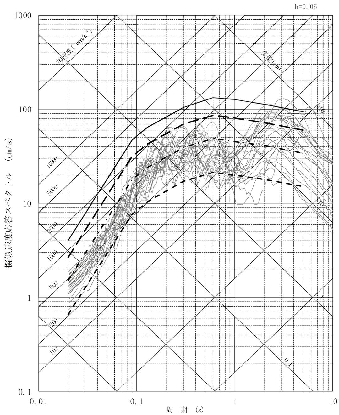
第 1.2.5.8.2 図(2) 基準地震動 Ss-2~Ss-22 と一様ハザードスペクトルの比較(鉛直方向)
