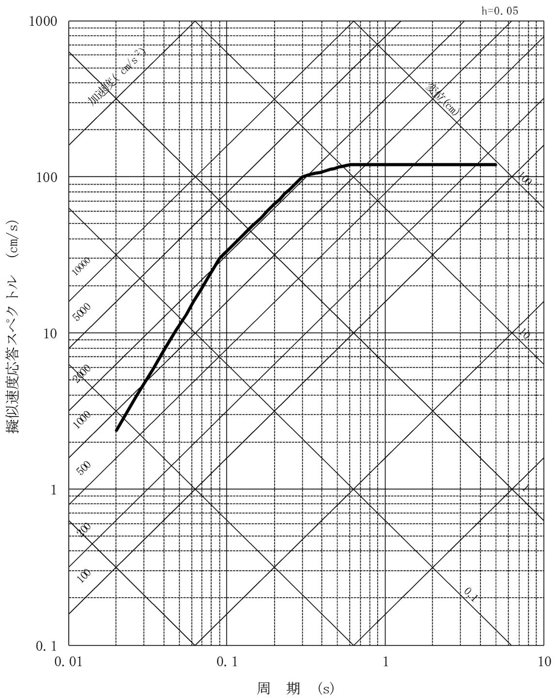
第 1.2.5.6.1 図(1) 基準地震動 Ss-1 の応答スペクトル (水平方向)
