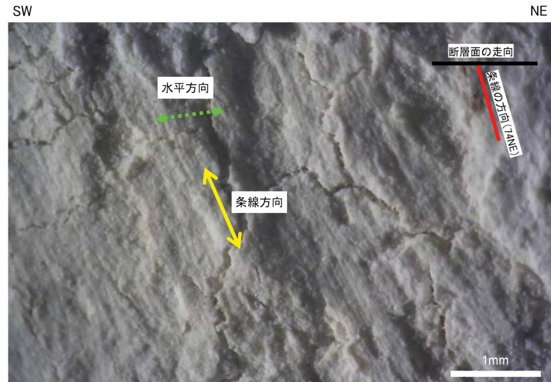
断層面の状況(下盤上面)
