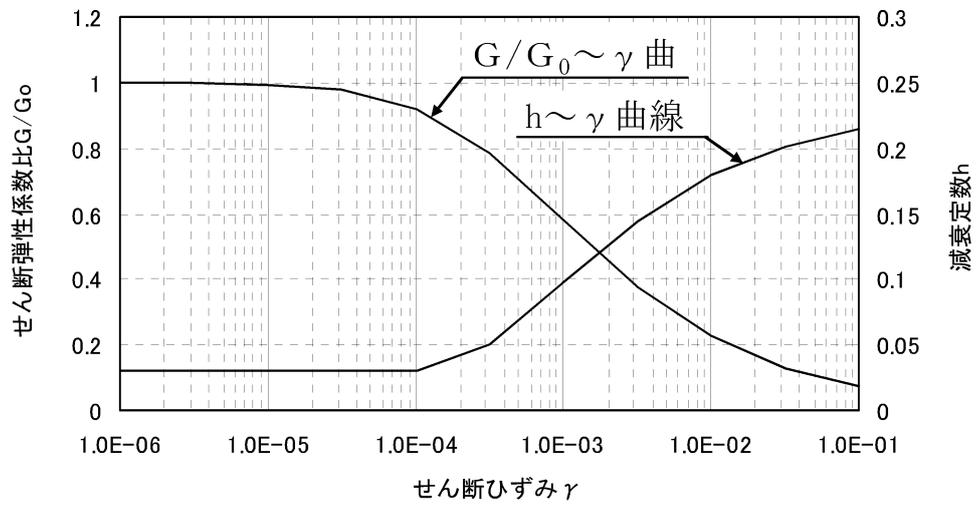
第1.2.3.5.8図 せん断弾性係数及び減衰定数のひずみ依存特性（破碎帯）
