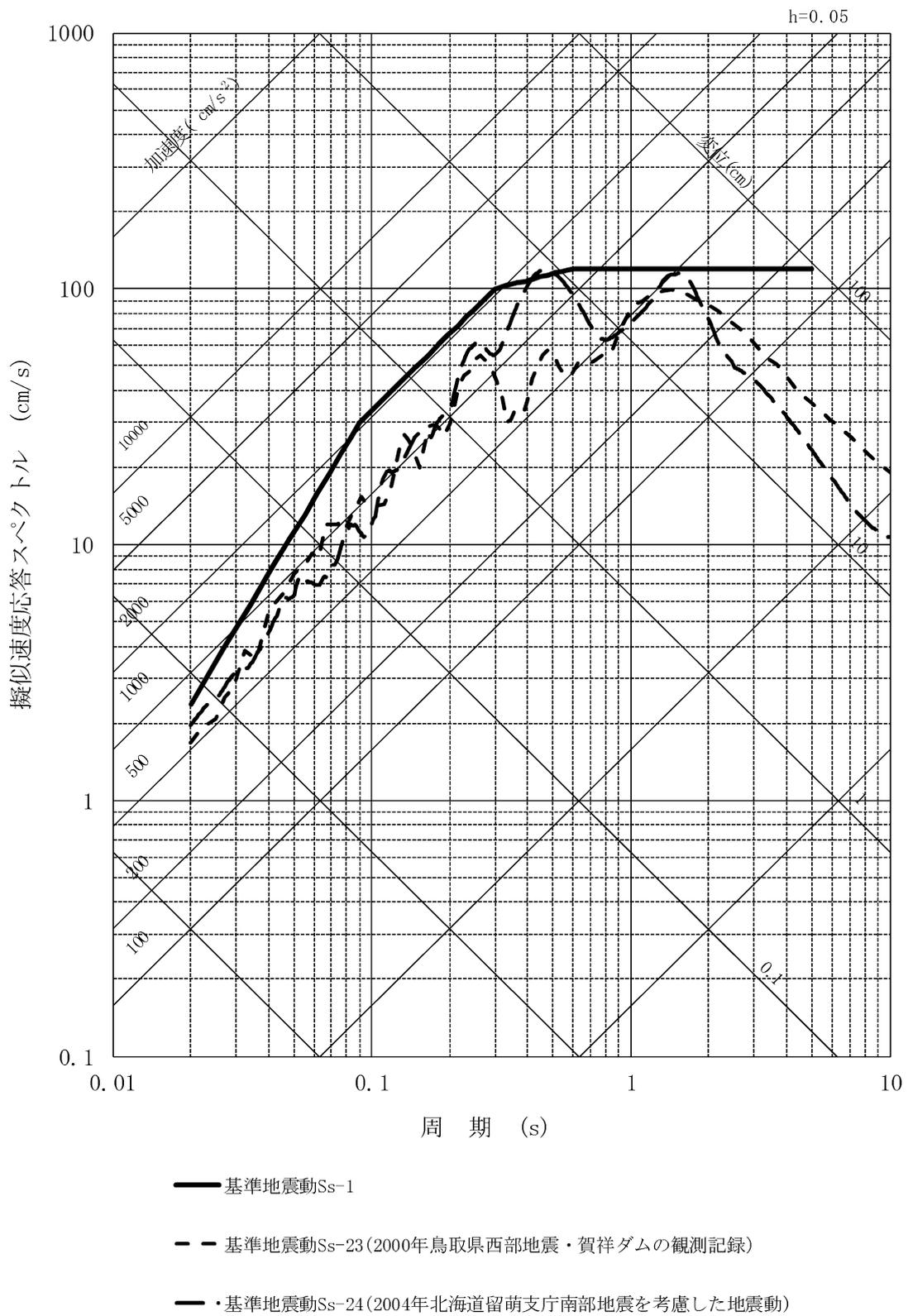
第 1.2.5.6.9 図(1) 基準地震動 Ss-1 と Ss-23, Ss-24 の応答スペクトル (NS 方向)
