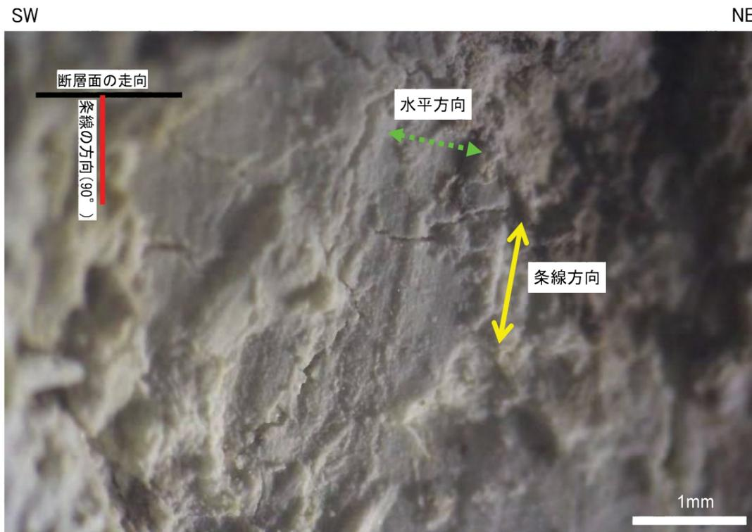
断層面の状況(下盤上面)
