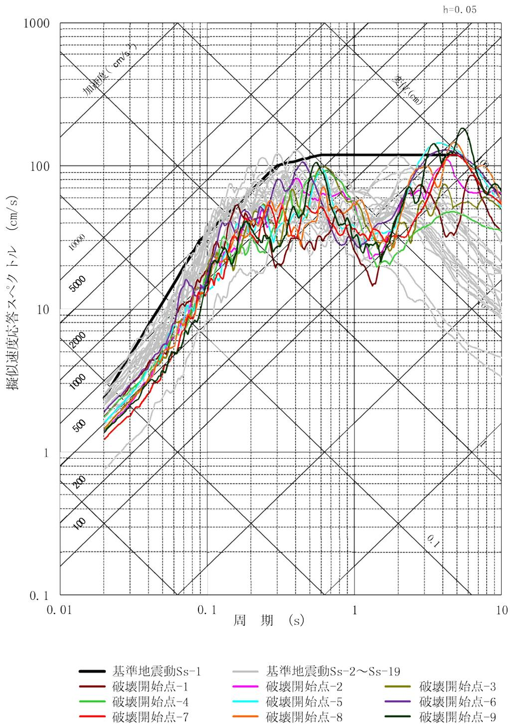
第 1.2.5.6.7 図(1) 基準地震動 Ss-1～Ss-19 の応答スペクトルと安島岬沖～和布一干飯崎沖～甲楽城断層～甲楽城沖断層～浦底断層～池河内断層～柳ヶ瀬山断層～柳ヶ瀬断層南部～鍛冶屋断層～関ヶ原断層による地震の断層モデルを用いた手法による地震動評価結果との比較 (NS 方向)
