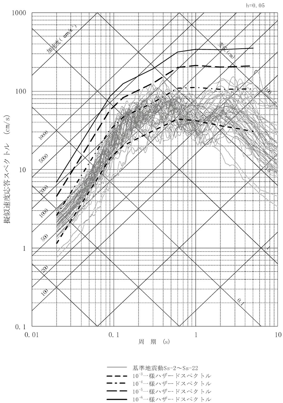
第 1.2.5.8.2 図(1) 基準地震動  $S_s-2 \sim S_s-22$  と一様ハザードスペクトルの比較(水平方向)
