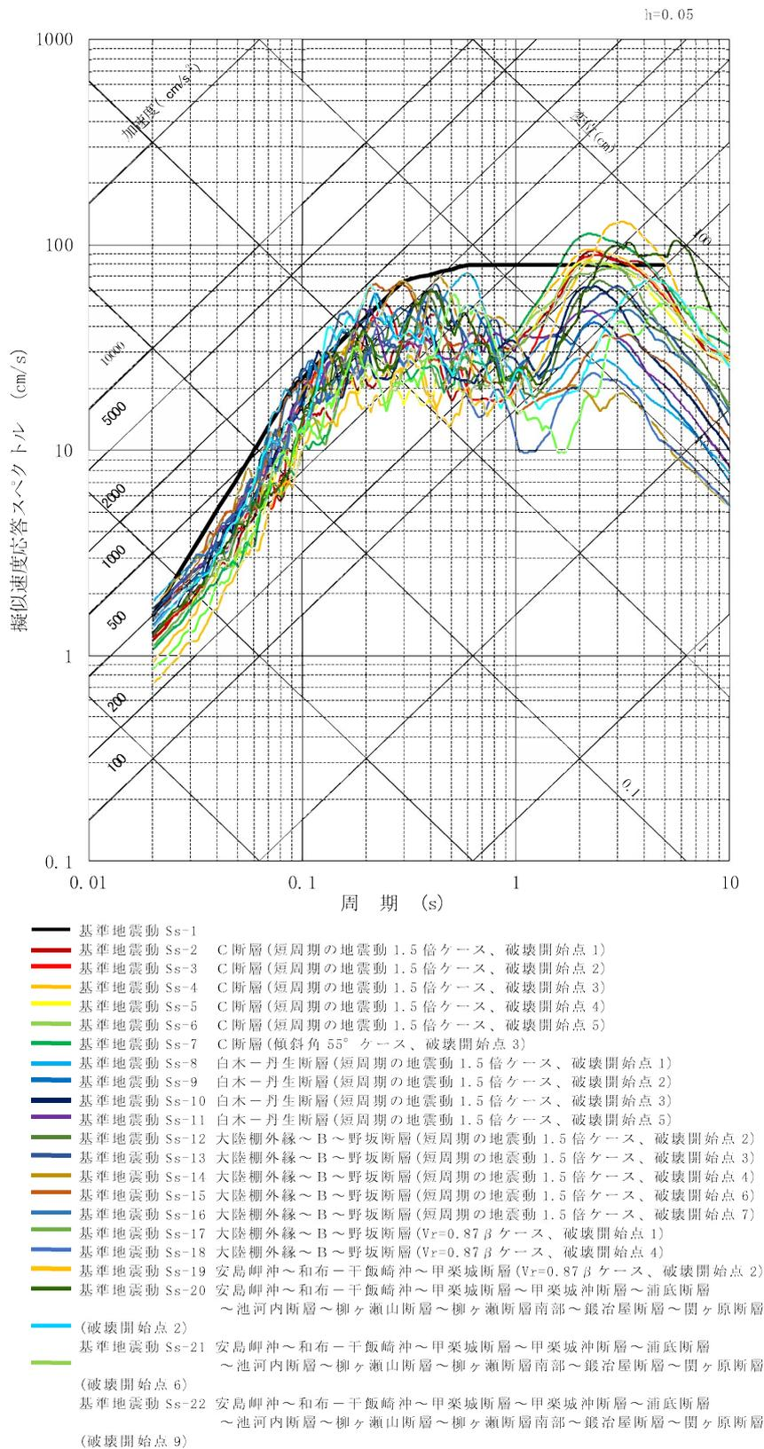
第 1.2.5.6.8 図(3) 基準地震動 Ss-1 と Ss-2～Ss-22 の応答スペクトル (UD 方向)
