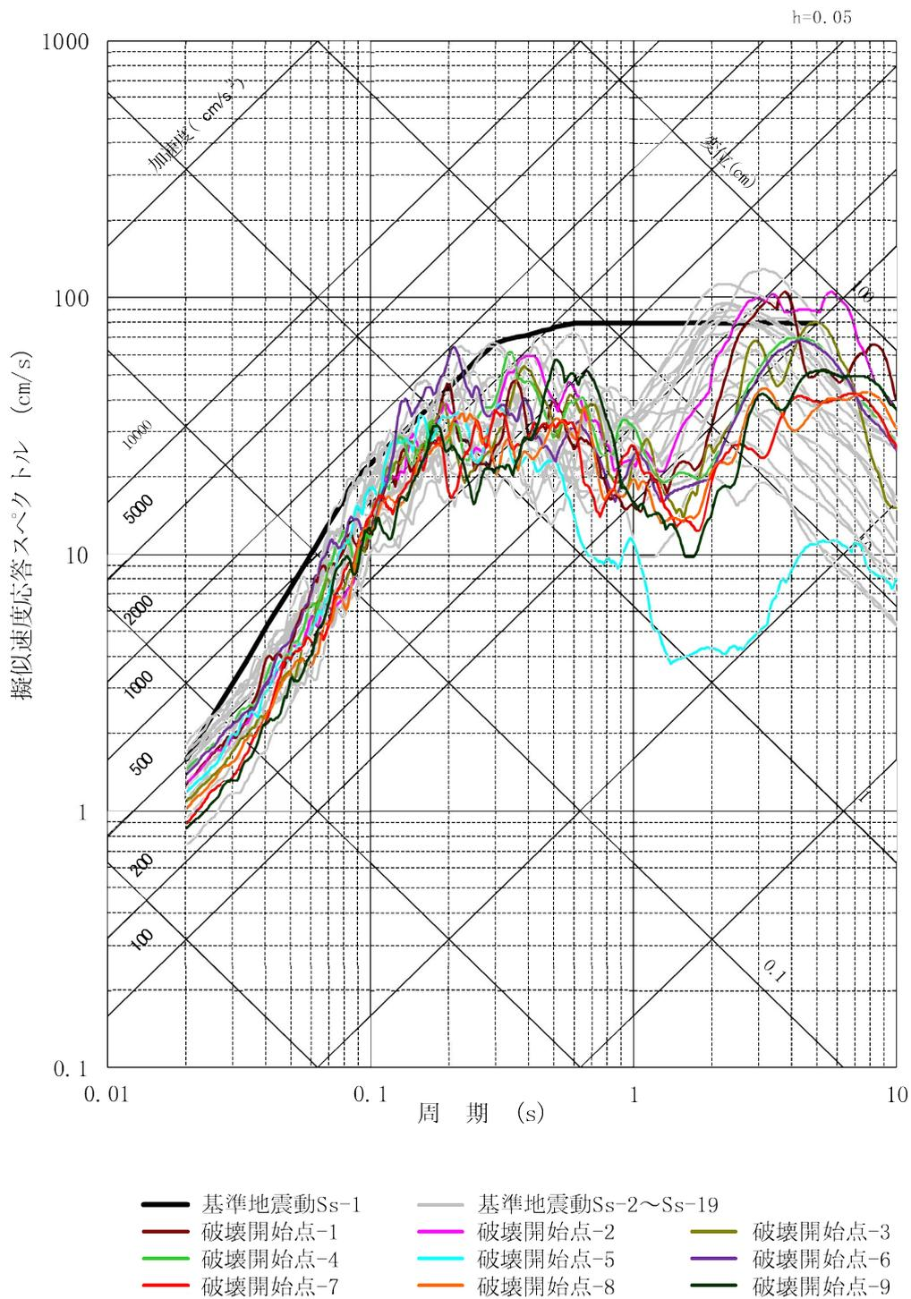
第 1.2.5.6.7 図(3) 基準地震動 Ss-1~Ss-19 の応答スペクトルと安島岬沖～和布一干飯崎沖～甲楽城断層～甲楽城沖断層～浦底断層～池河内断層～柳ヶ瀬山断層～柳ヶ瀬断層南部～鍛冶屋断層～関ヶ原断層による地震の断層モデルを用いた手法による地震動評価結果との比較 (UD 方向)
