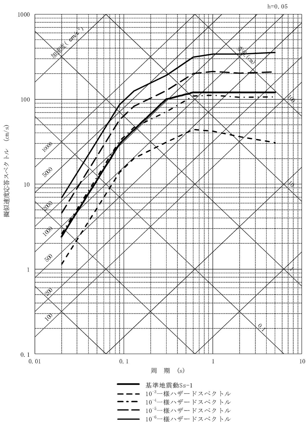
第 1.2.5.8.1 図(1) 基準地震動 Ss-1 と一様ハザードスペクトルの比較 (水平方向)
