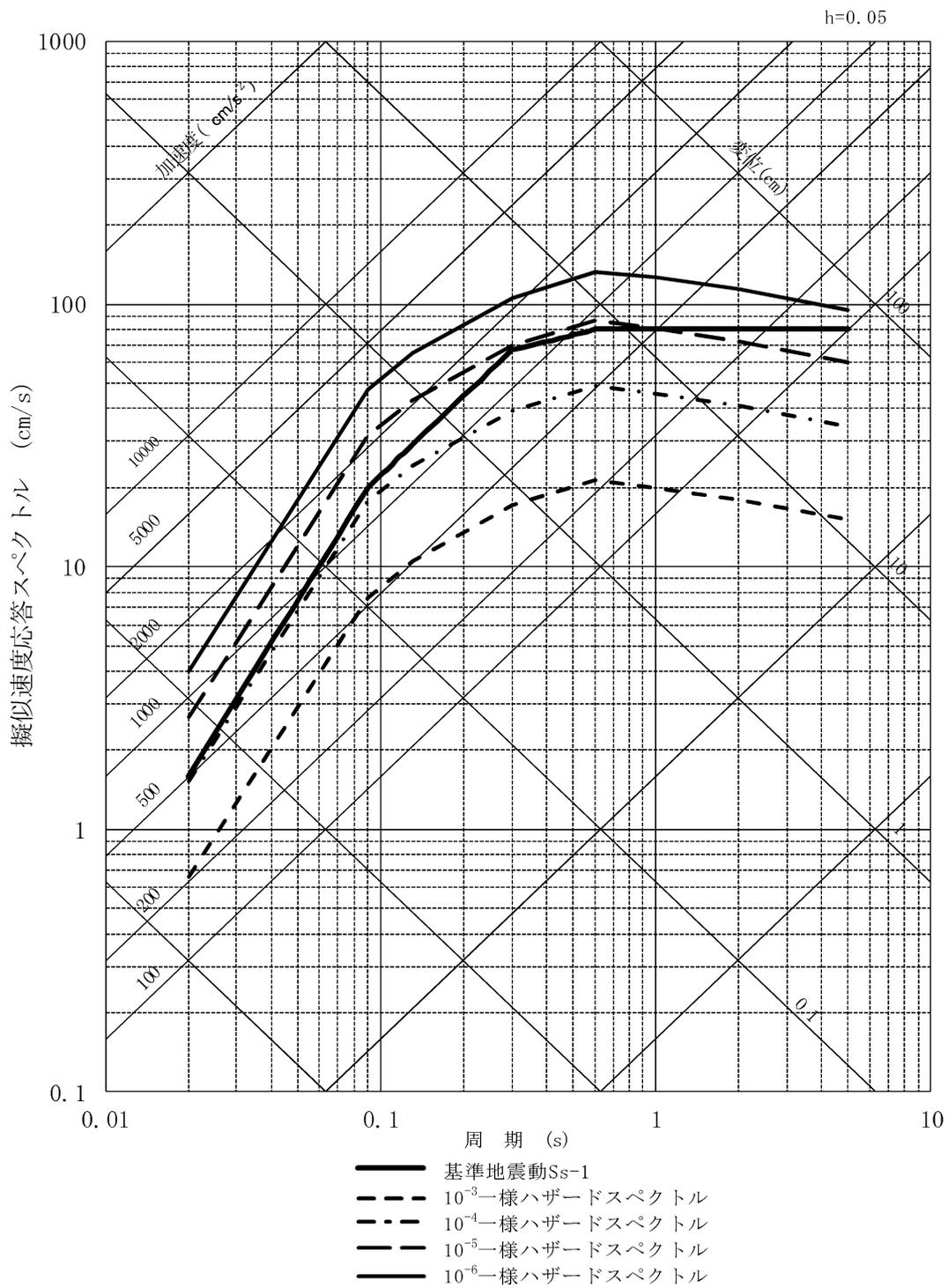
第 1.2.5.8.1 図(2) 基準地震動  $S_s-1$  と一様ハザードスペクトルの比較 (鉛直方向)
