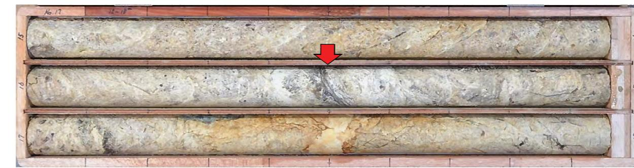
M1-13孔 77.1m付近 粘土状破碎部(N22E/68W)
