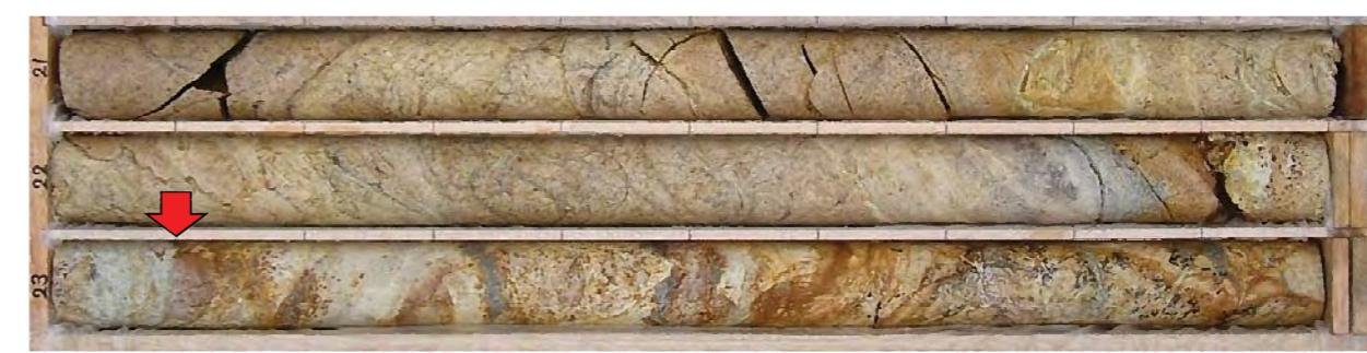
M1-10孔 66.7m付近 磕混じり粘土状破碎部(N24E/73E)
