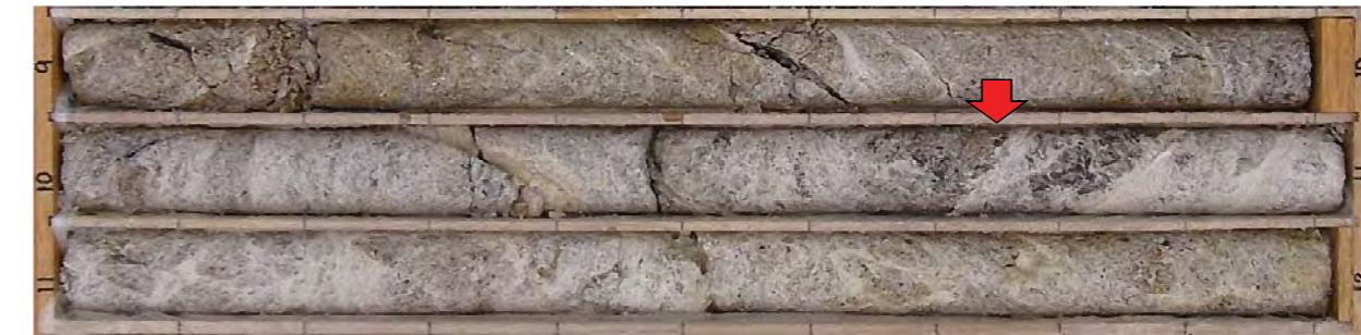
No.17孔 16.5m付近 粘土状破碎部(N14W/60W)
