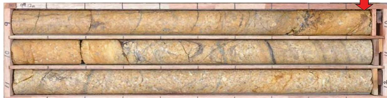
M3-13孔 29.25m付近 砂混じり角礫状破碎部(N54E/51S)
