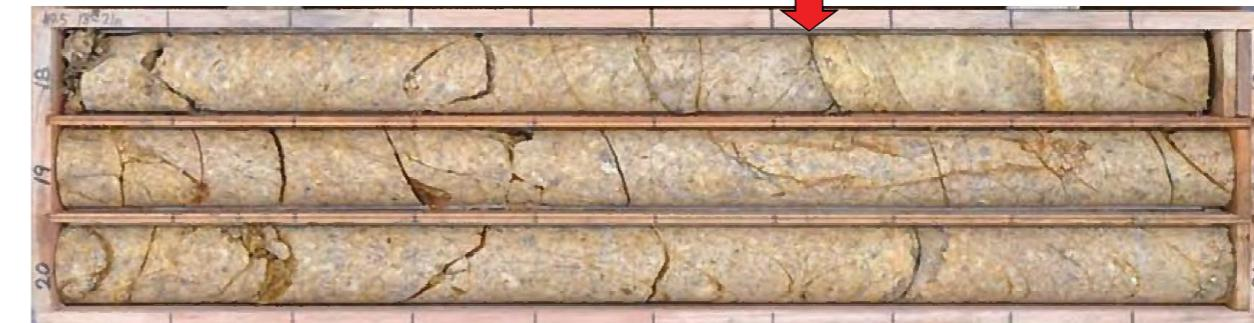
M3-13孔 47.4m付近 固結した砂状破碎部(N78E/58SE)
