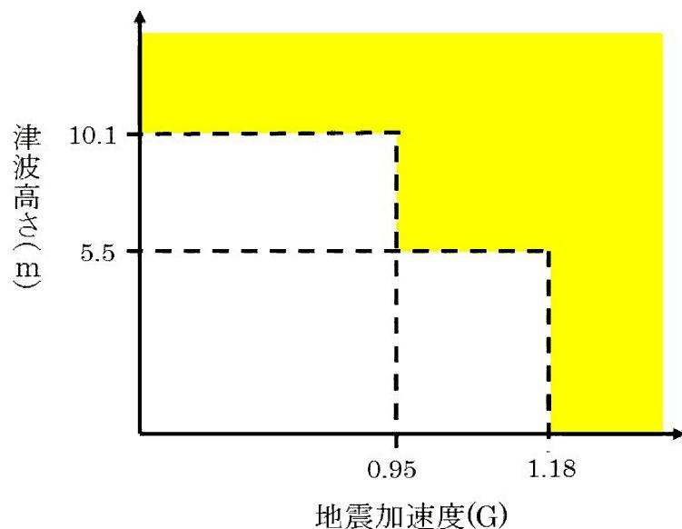
第 3.1.4.2.3.2 図 地震と津波の重畠に関するクリフエッジ評価結果
