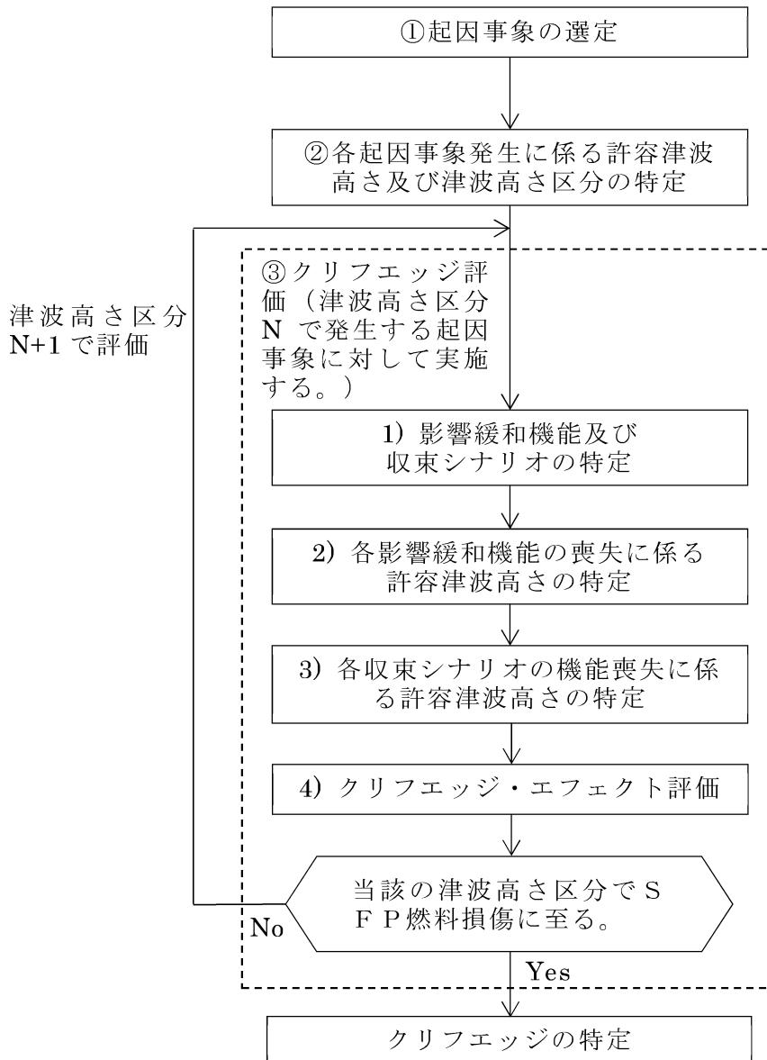
第 3.1.4.2.2.4 図 クリフェッジの特定に係るフロー図（津波：SFP 燃料損傷）
