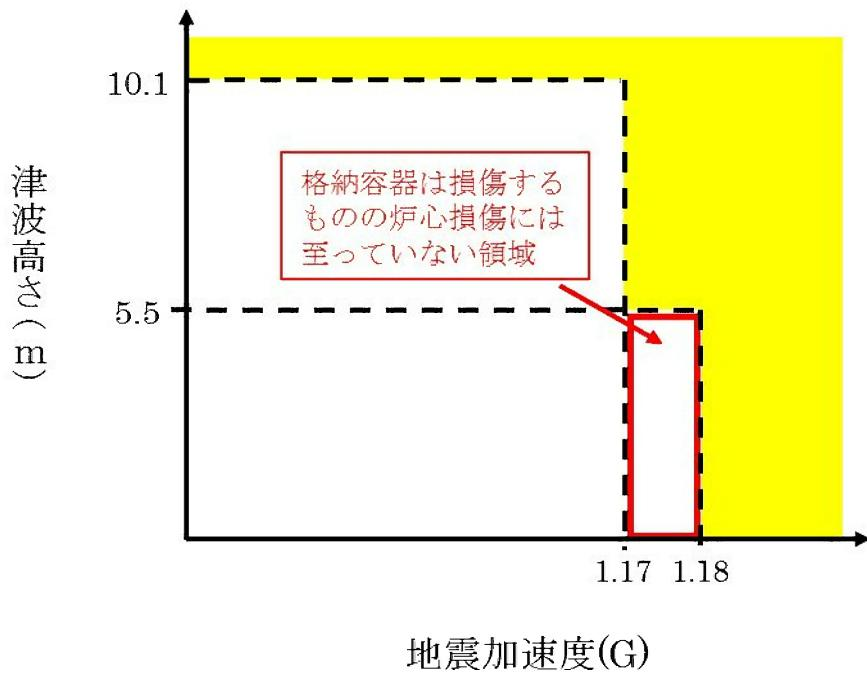
第 3.1.4.2.3.4 図 地震と津波の重畠に関するクリフェッジ評価結果
