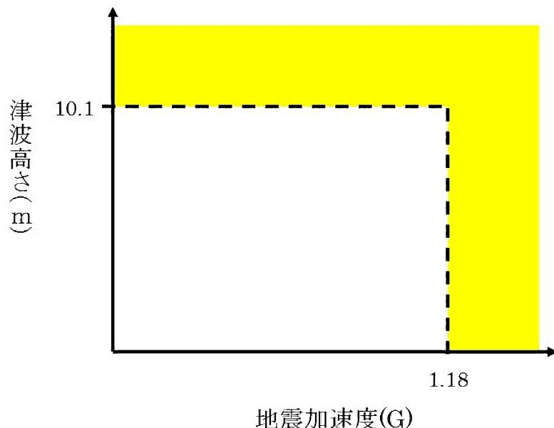
第 3.1.4.2.3.3 図 地震と津波の重畠に関するクリフェッジ評価結果
