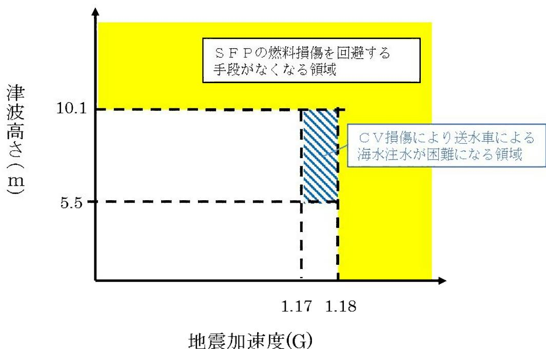
第 3.1.4.2.3.5 図 地震と津波の重畠に関するクリフェッジ評価結果
