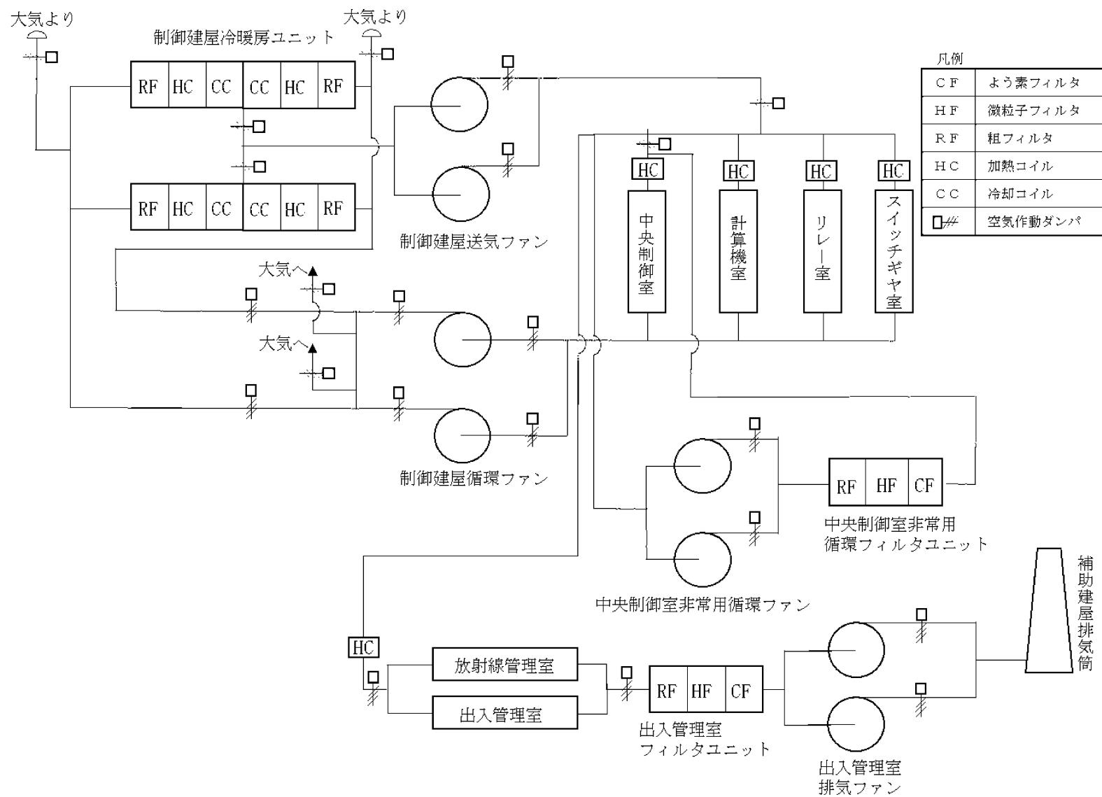
第 3.1.3.1.1.1.23 図 中央制御室換気空調設備概略図
