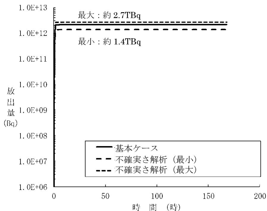
第 3.1.3.1.1.4.3 図 格納容器健全の Cs-137 放出量不確実さ解析結果
