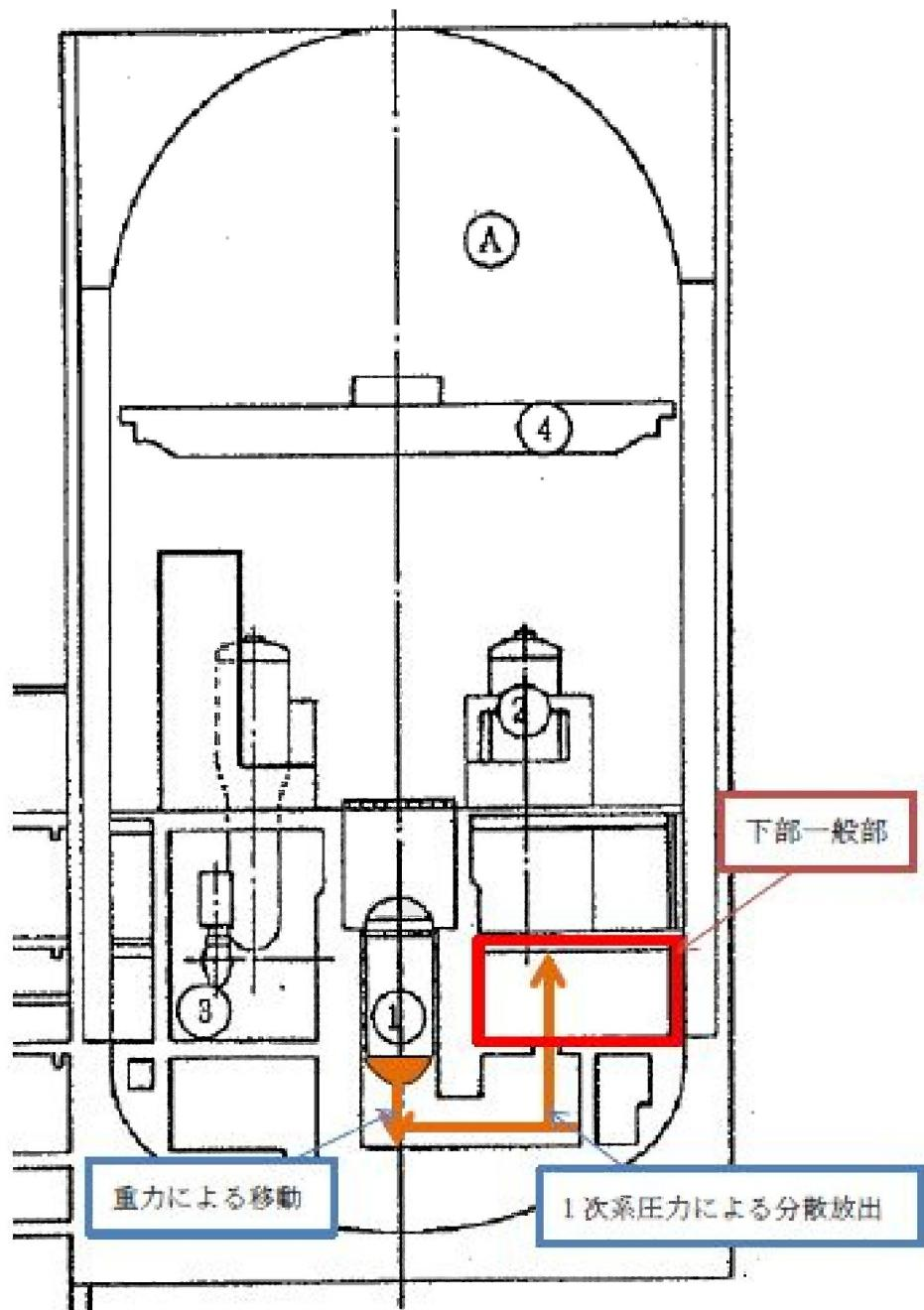
第 3.1.3.1.1.1.29 図 美浜 3 号機 燃料及び溶融炉心の移動経路の概略図
