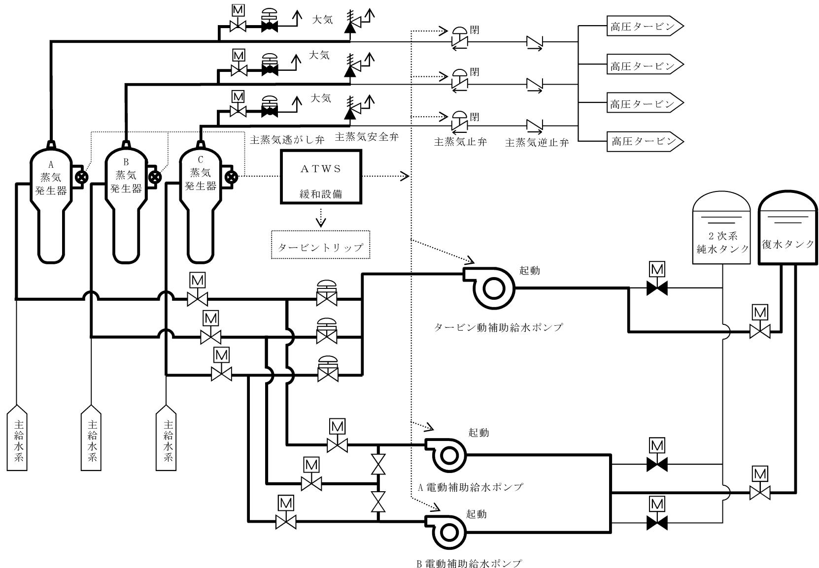
第 3.1.3.1.1.3 図 多様化自動作動設備（ATWS 緩和設備）概略図
