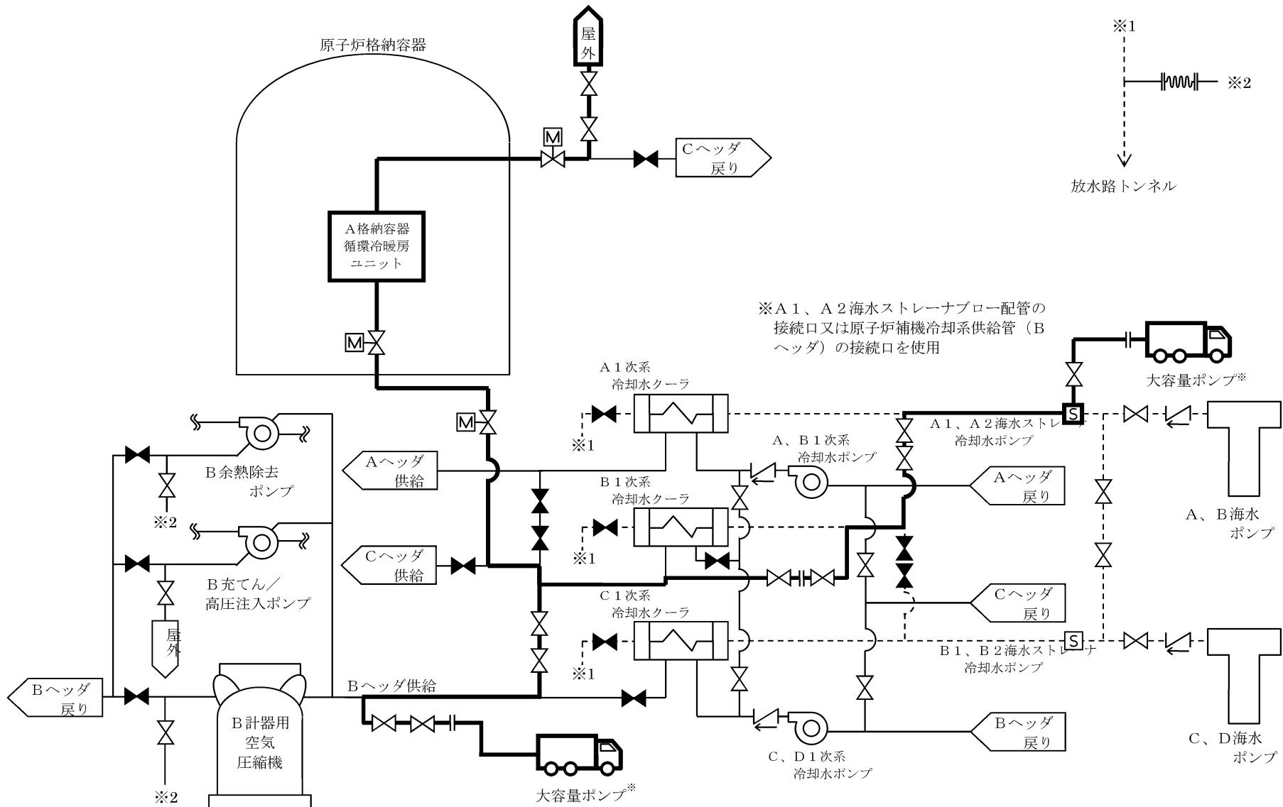
第 3.1.3.1.1.1.16 図 格納容器内自然対流冷却 (海水通水時) 概略図
