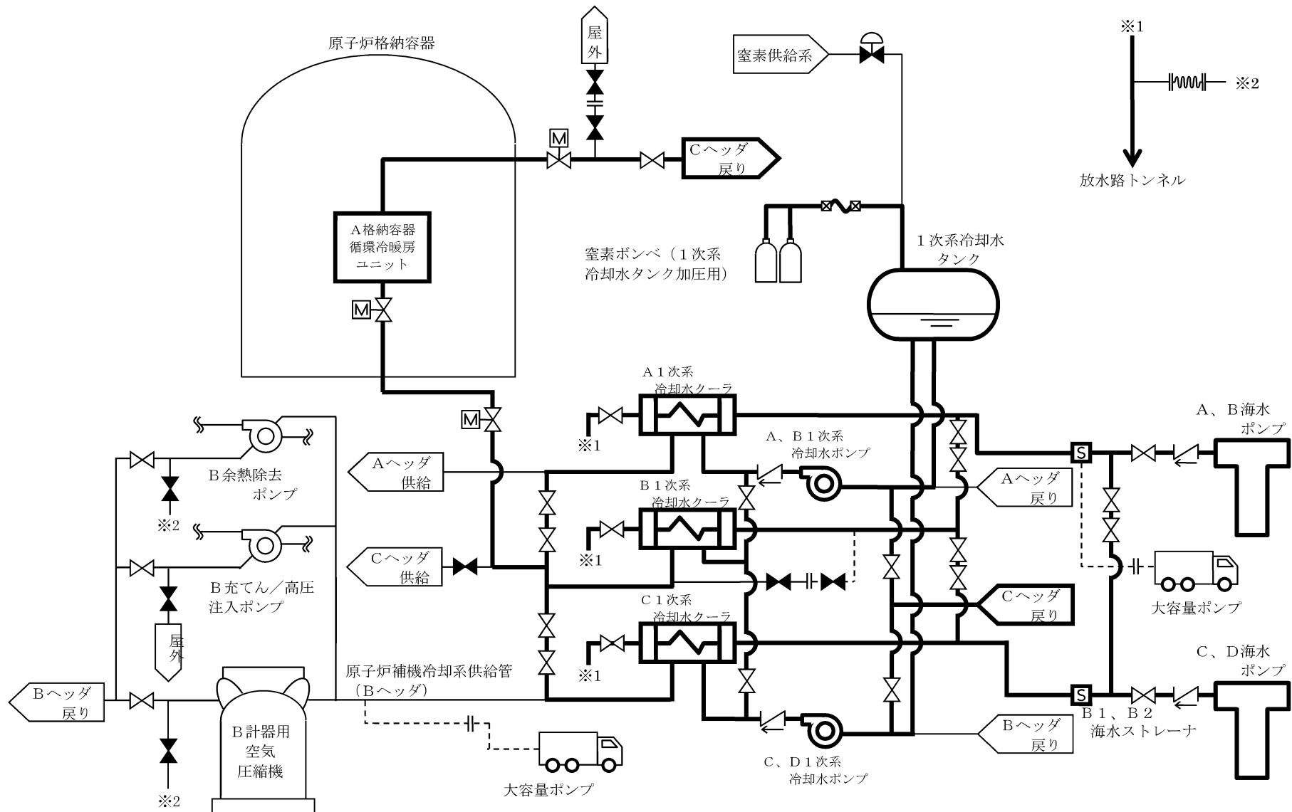
第 3.1.3.1.1.15 図 格納容器内自然対流冷却（原子炉補機冷却水通水時）概略図
