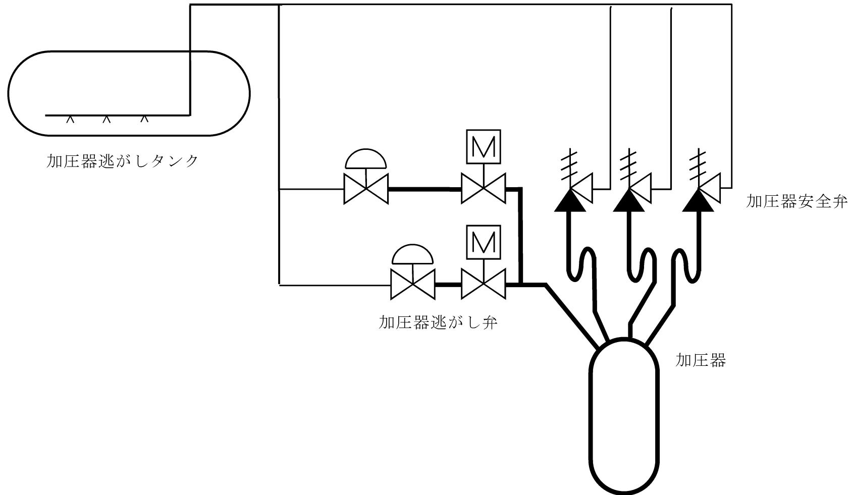
第 3.1.3.1.1.8 図 加圧器逃がし弁による 1 次冷却材系統の減圧概略図
