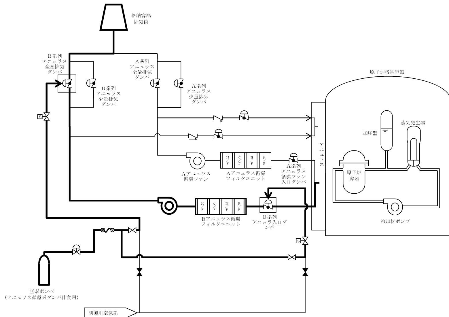
第 3.1.3.1.1.1.14 図 窒素ボンベによるアネラス循環系ダンパーへの駆動用空気の供給概略図
