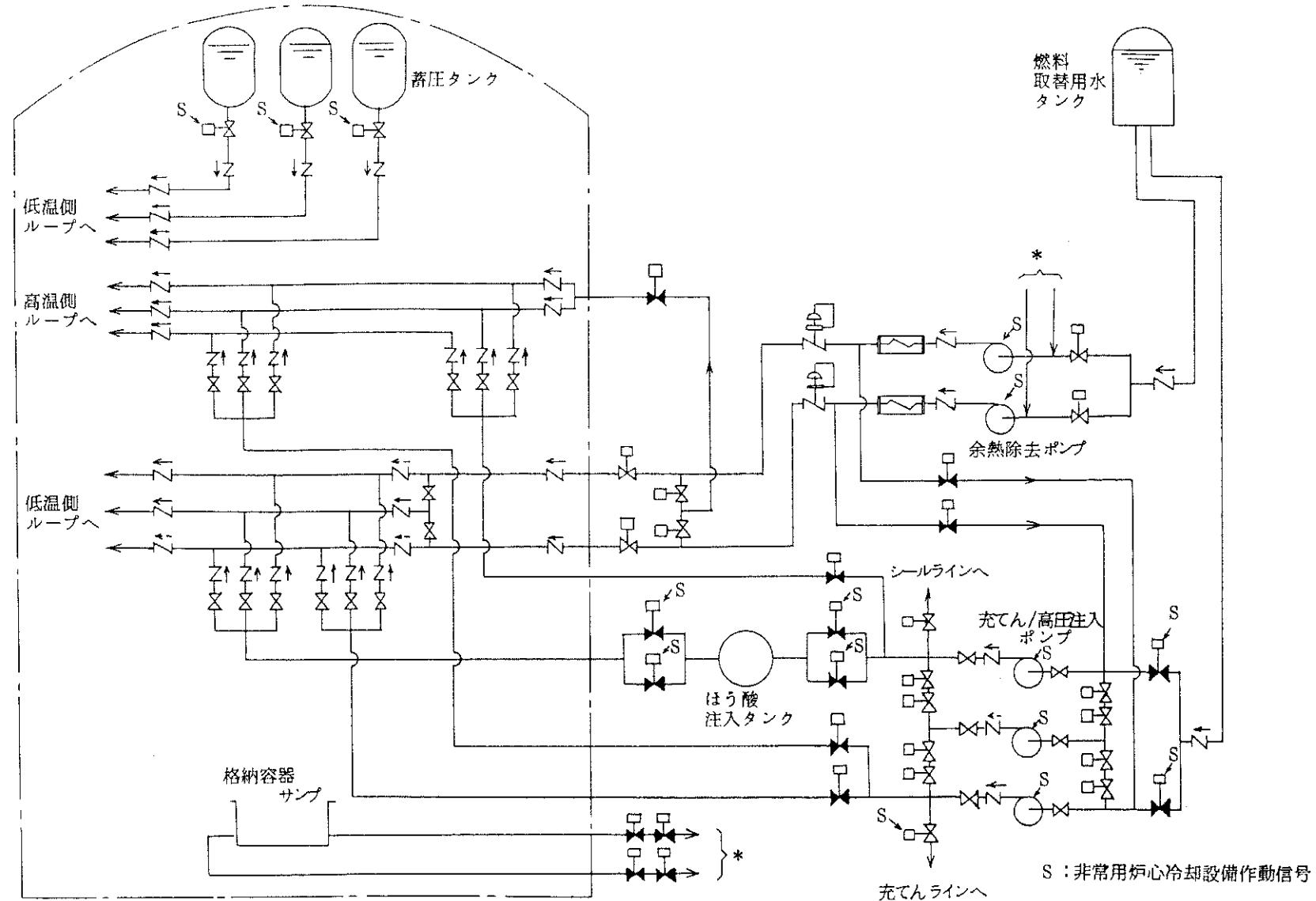
第 3.1.3.1.1.1.6 図 非常用炉心冷却設備概略図
