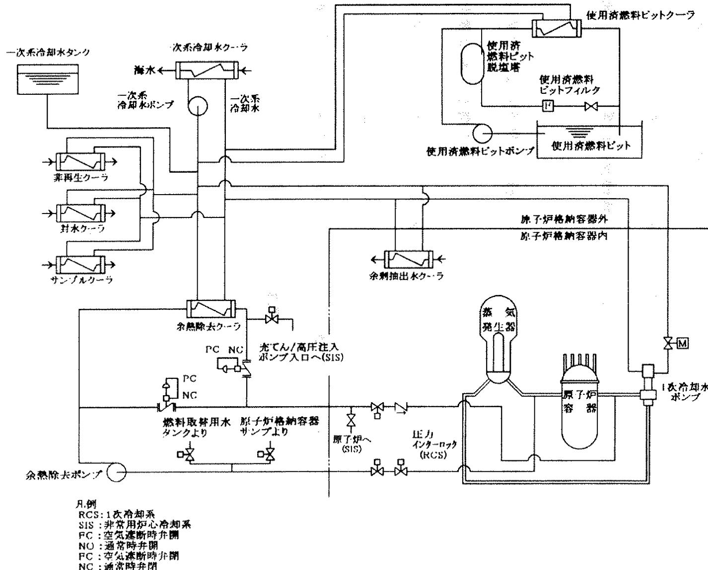
第 3.1.3.1.1.5 図 余熱除去設備概略図
