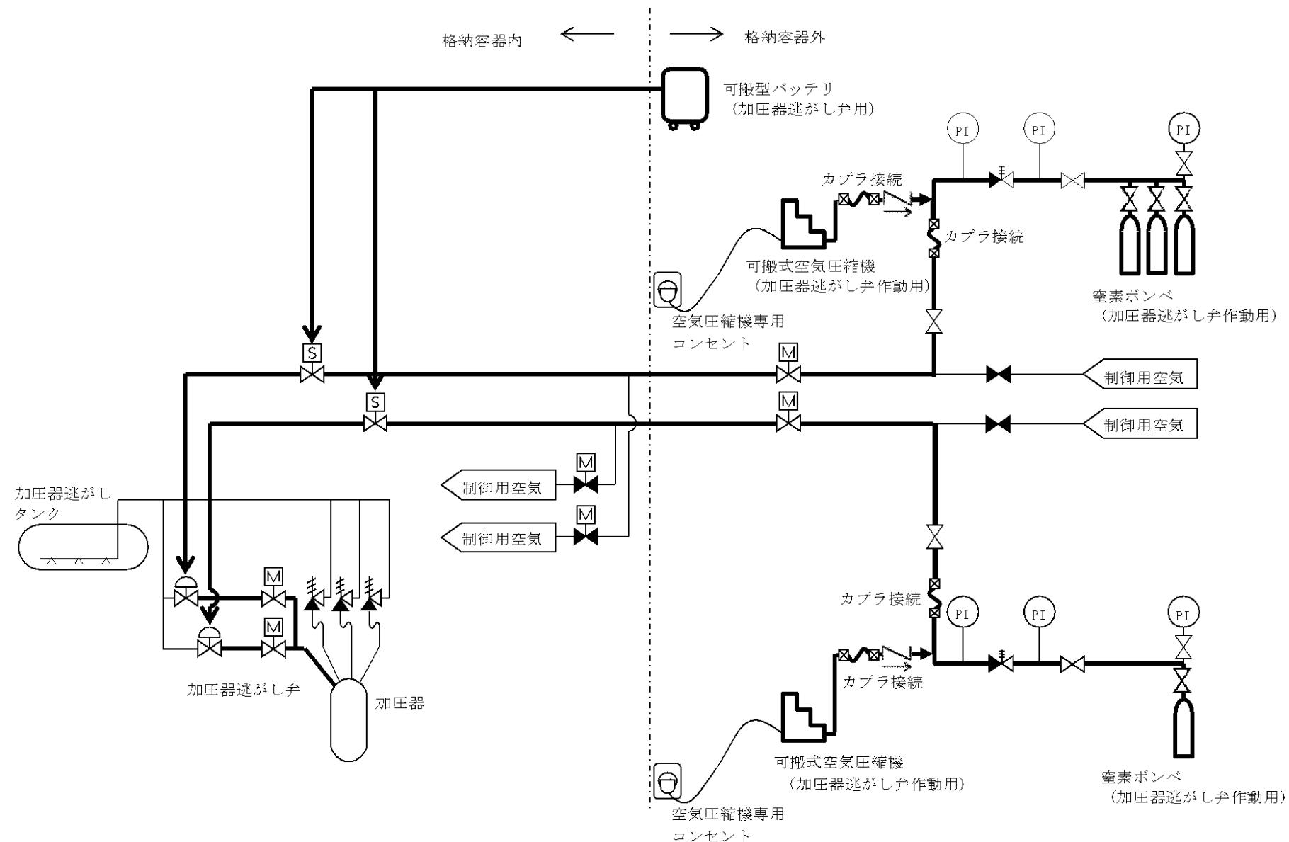
第 3.1.3.1.1.9 図 窒素ボンベによる加圧器逃がし弁への駆動用空気の供給概略図
