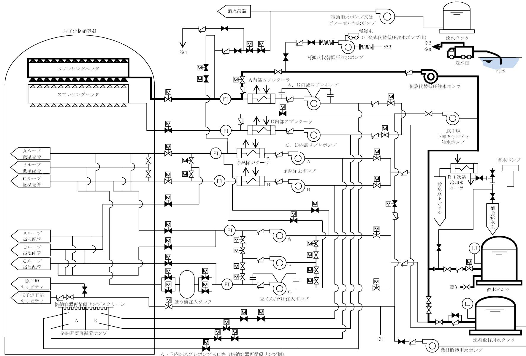
第 3.1.3.1.1.1.17 図 恒設代替低圧注水ポンプによる代替格納容器スプレイ概略図
