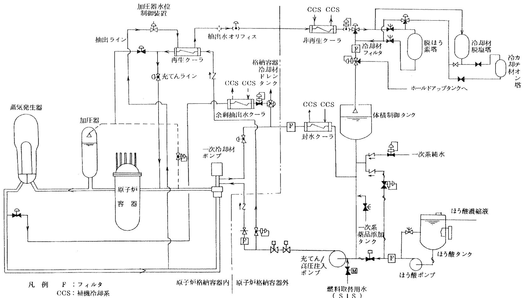
第 3.1.3.1.1.1.2 図 化学体積制御設備概略図
