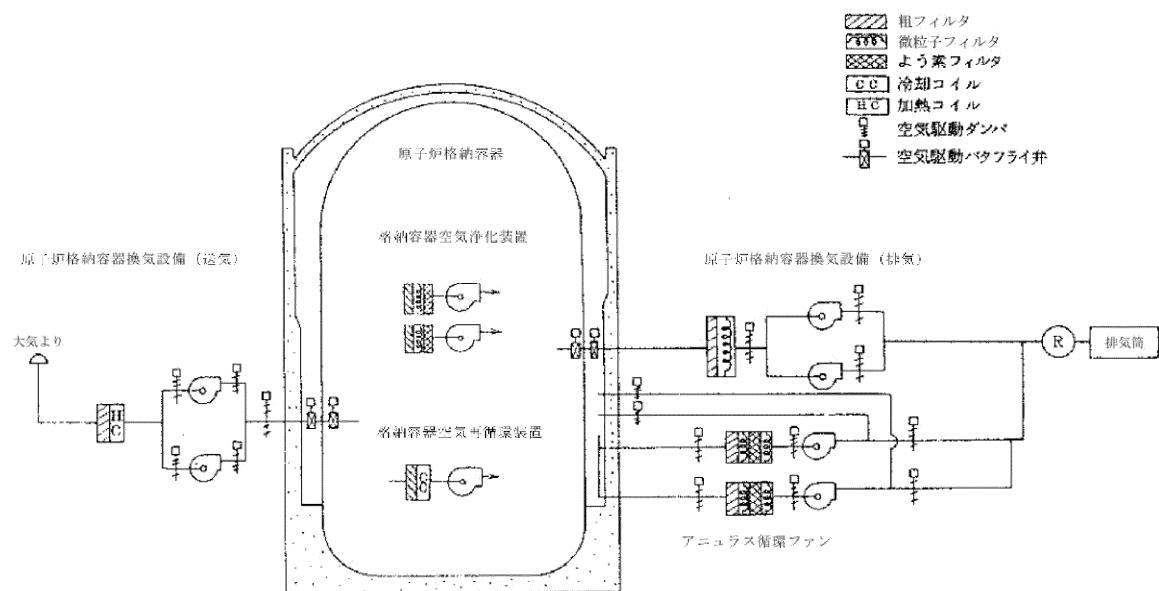
第 3.1.3.1.1.1.13 図 アニュラス空気再循環設備系統概略図
