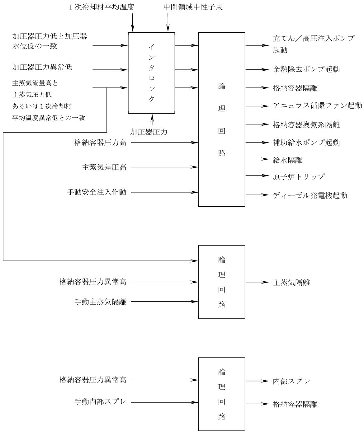
第 3.1.3.1.1.1.21 図 工学的安全施設作動設備概略図
