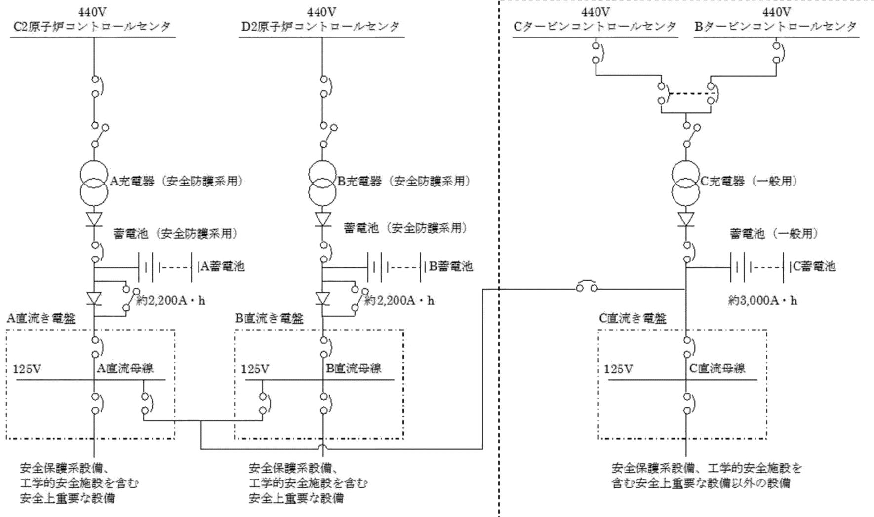
第 3.1.3.1.1.1.19 図 非常用電源設備（蓄電池）直流单線結線図概略図
