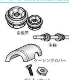
部品レベルにまで分解し、劣化の状況の評価
