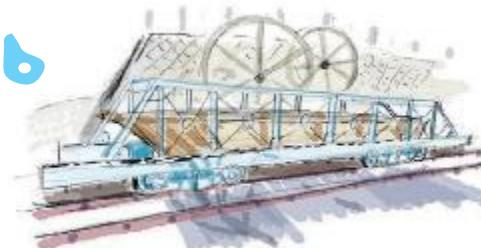
蹴上船溜から南禅寺船溜まで延長約582m、高低差約36mの落差を克服し、舟を通航させるために敷設された傾斜鉄道。ワイヤーロープにつないだ台車を巻上機(ワインチ)で上下させるしくみで、動力には蹴上発電所で発電した電気が用いられました。
