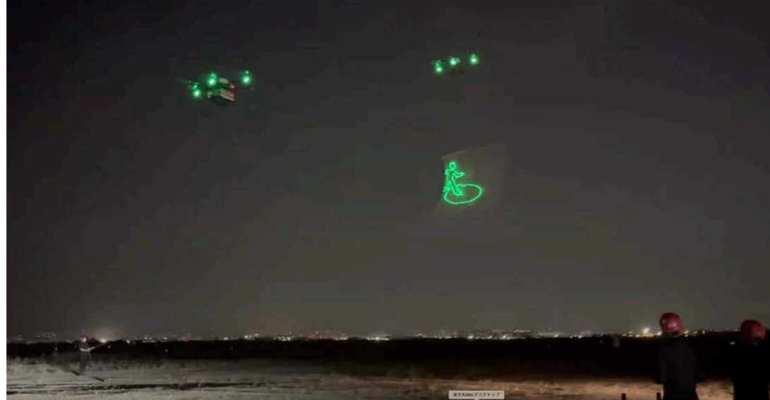
上/夢洲での実証実験で飛行と投影に成功した 左/ドローンに搭載した透過型スクリーンとレーザー プロジェクターで空中に画や文字を表示する
