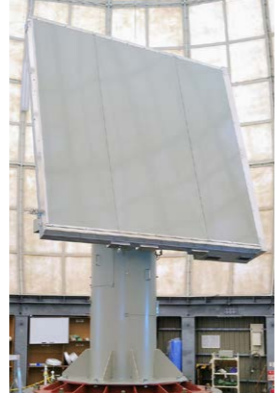
左/気象レーダーのアンテナ部分(提供:東芝) 下/大阪大学吹田キャンパスに設置された気象レーダー(提供:大阪大学)
