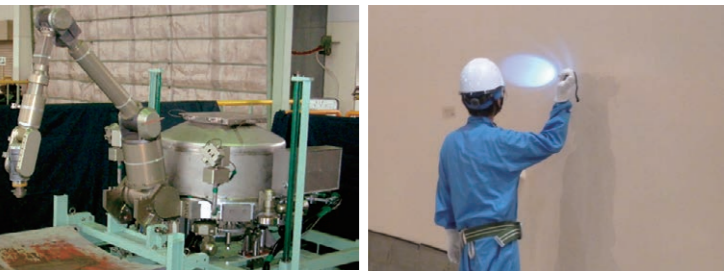
原子炉容器内を点検するためのロボット
