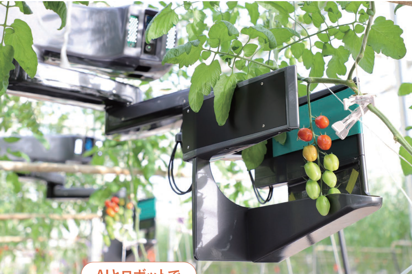
左右2本の収穫ハンドでトマトの房をはさみ、ねじって収穫
