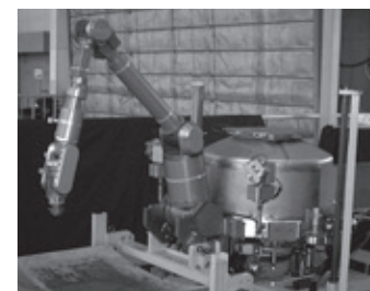
遠隔操作で炉心領域の 欠陥の有無を調べる検査ロボット
