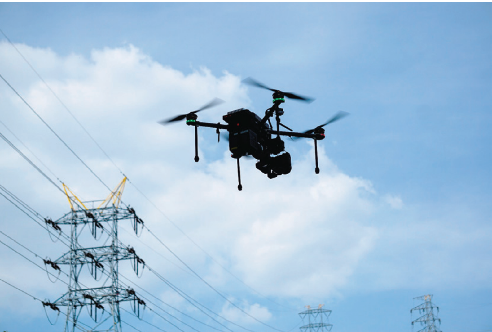
安定供給を使命とする関西電力も、生産性向上と新たな価値の創出、2方向からDXを加速させようとしている。写真はドローン活用で効率化を図っている送電線点検作業
