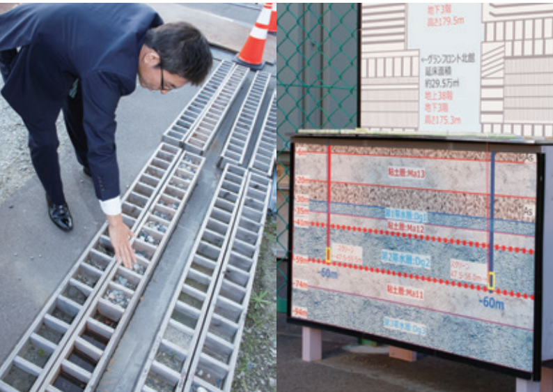
地下60mの地質状況。 粘土層と帯水層が交互に層を形成している
